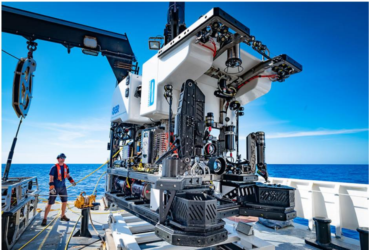
Slika 2-3. Daljinski upravljana ronilica, ROV (preuzeto iz [9])
