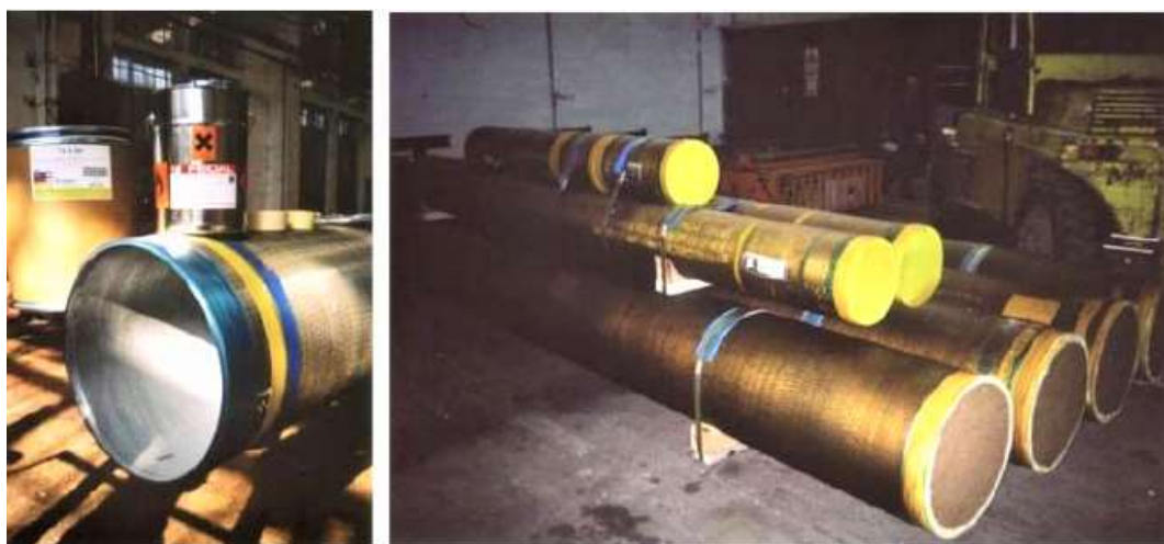
Slika 5.7. Zaštita unutrašnjosti cijevi praškastim inhibitorima [22]
