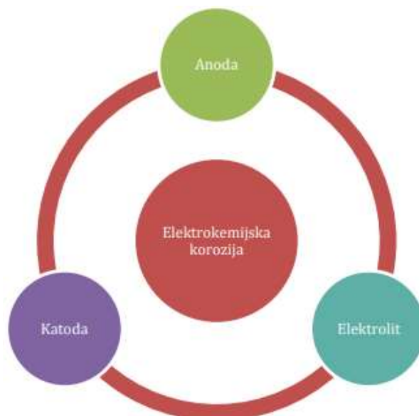
Slika 2.3. Uvjeti elektrokemijske korozije [5]
