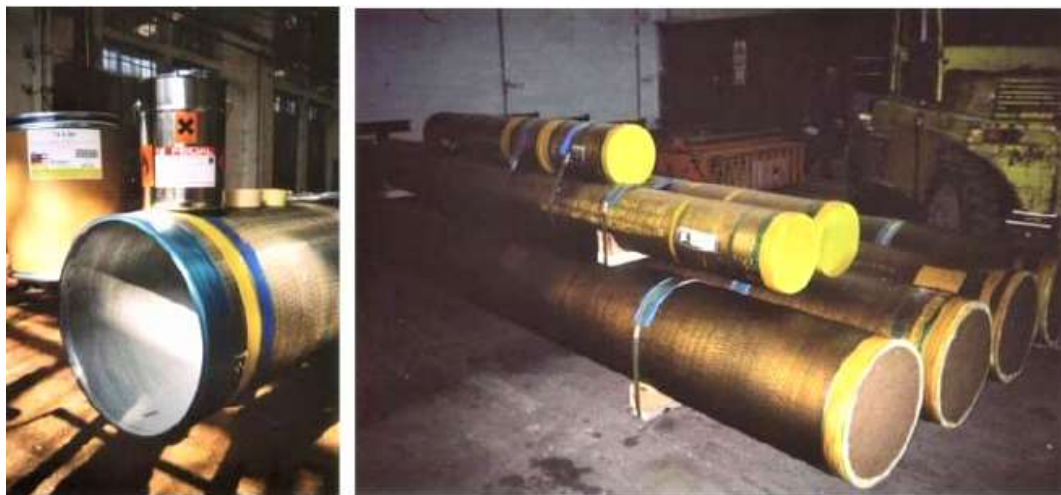
Slika 5.7. Zaštita unutrašnjosti cijevi praškastim inhibitorima [22]
