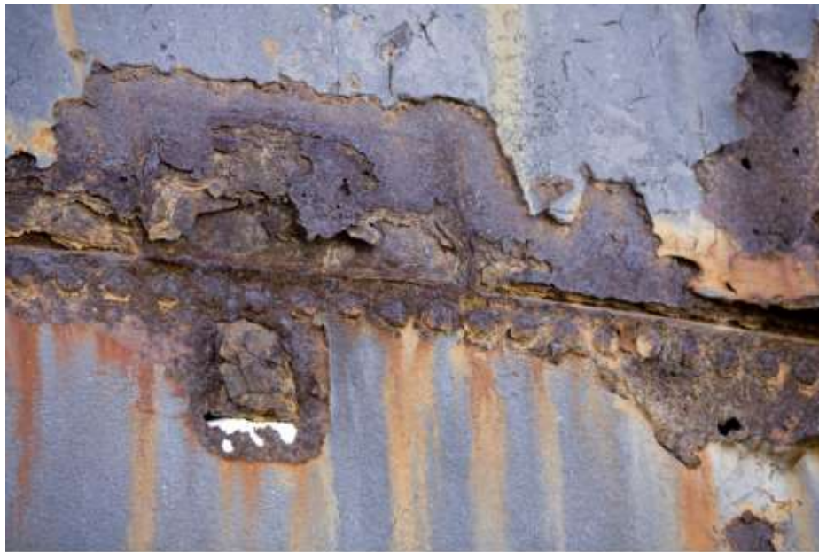
Slika 3.5. Primjer listanja metala [8]
