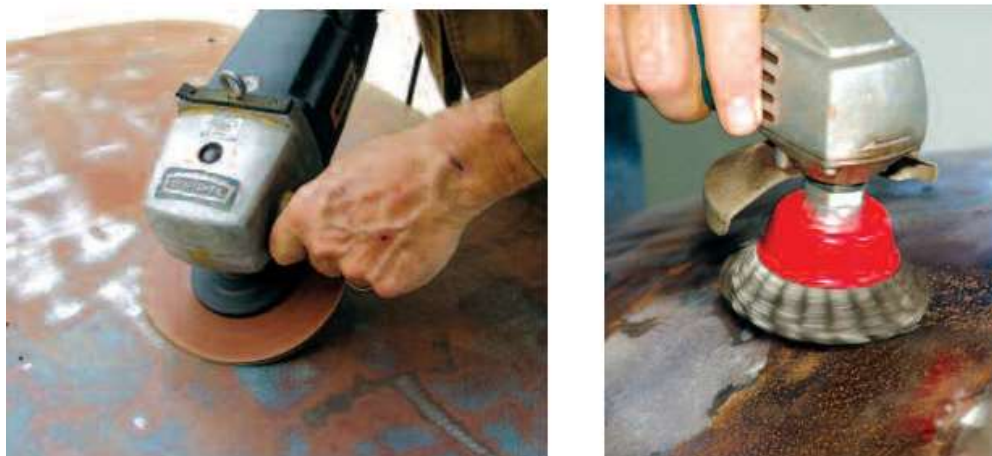
Slika 4.2. Brušenje brusnim papirom i žičanom četkom [12]
