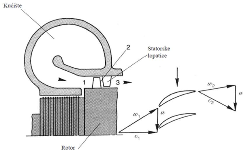
Slika 2.1.1: Shema jednog stupnja aksijalnog turbokompresora s trokutima brzina na ulazu i izlazu iz rotora
