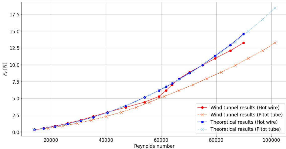
Slika 6.1 Odstupanja eksperimentalnih i teorijskih vrijednosti sile otpora
