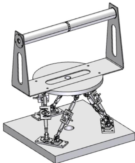
Slika 3.8 Stewartova platforma s prihvavnim nosačima na koje je pričvršćen model valjka [15]
