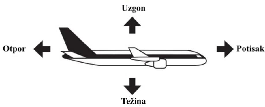
Slika 2.2 Četiri sile leta prikazane na zrakoplovu [6]
