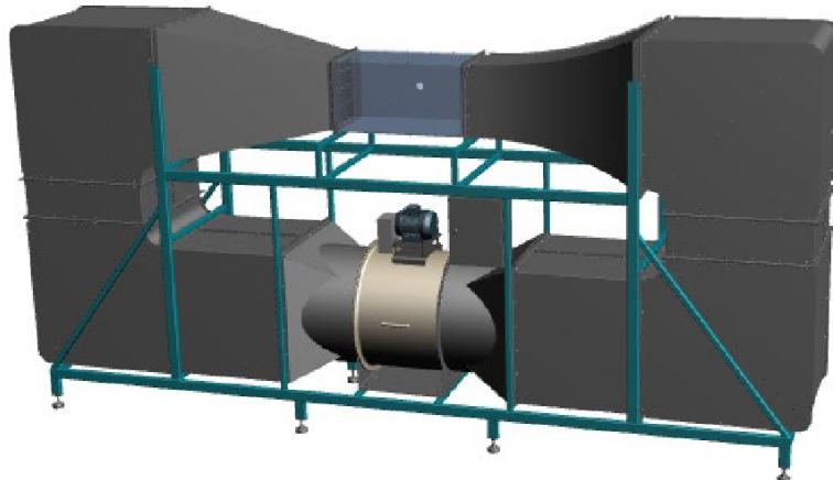
Slika 5.1 Model zračnog tunela na fakultetu
