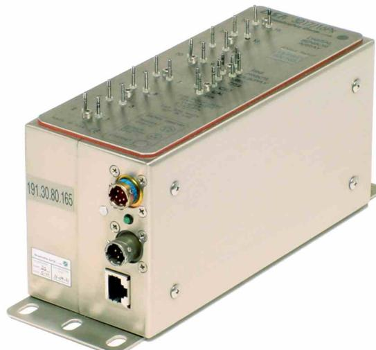
Slika 3.6 Mjerač tlaka (engl. Pressure scanner) Scanivalve DSA3217 [14]
