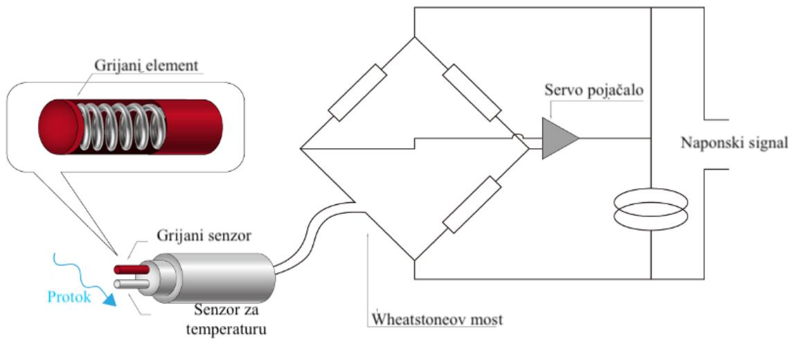
Slika 3.5 Shema principa rada hot - wire-a [12]
