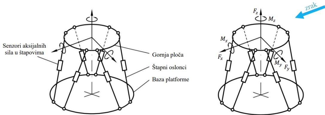
*Slika 3.7 Dijelovi senzora i komponente sile na temelju Stewartove platforme [15]*
