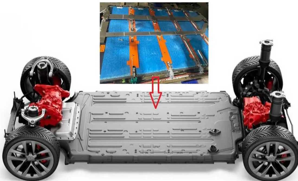
Slika 2.10. Baterija električnog vozila Tesla Model S
