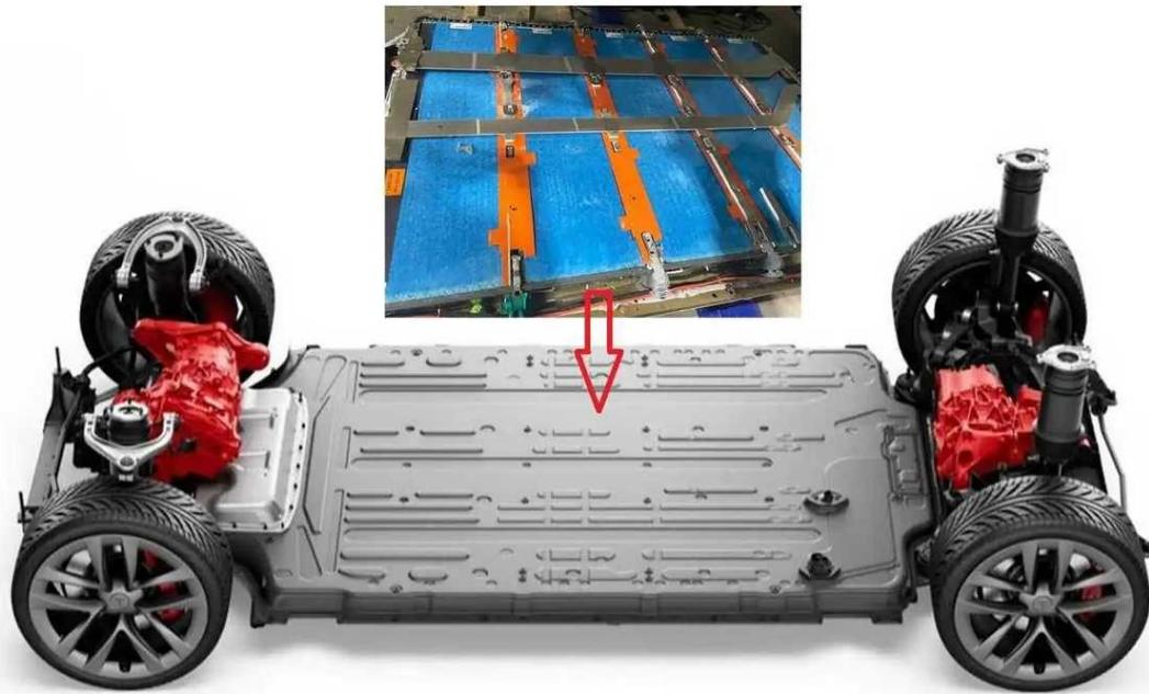
Slika 2.10. Baterija električnog vozila Tesla Model S
