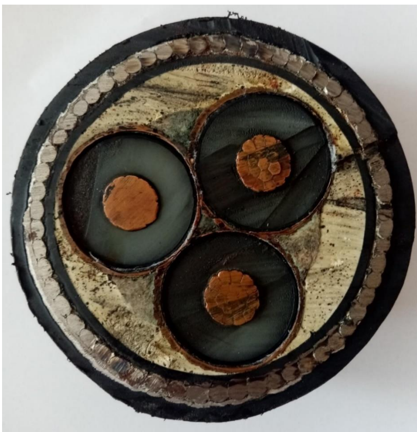
Slika 2.1. Presjek trožilnog podmorskog kabela
