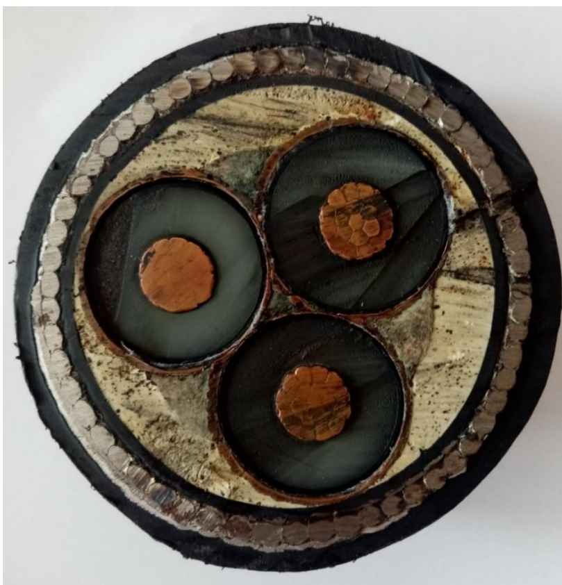
Slika 2.1. Presjek trožilnog podmorskog kabela
