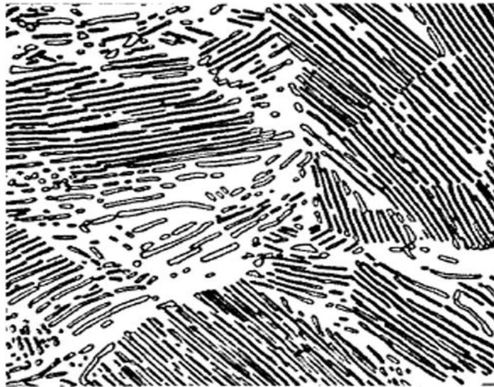
*Slika 6 Mikrostruktura perlita [6]*
