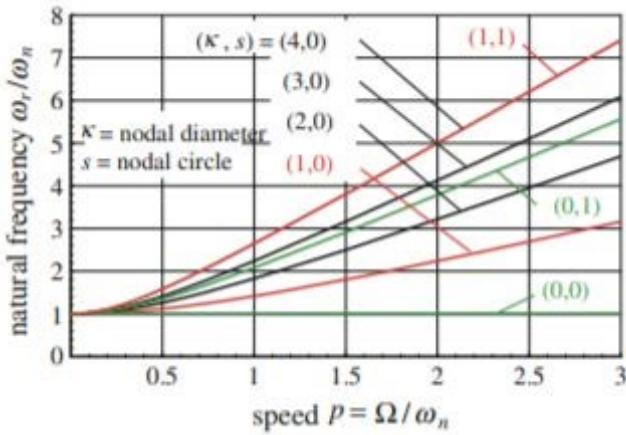
Slika 2.9. Centrifugalni učinak za primjer diska [3]
