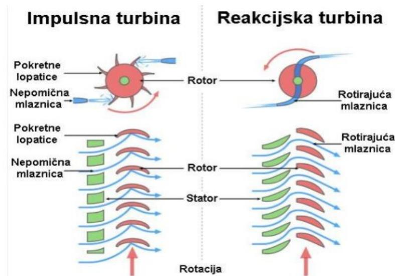
Slika 3.12. Princip akcijske i reakcijske turbine [6]
