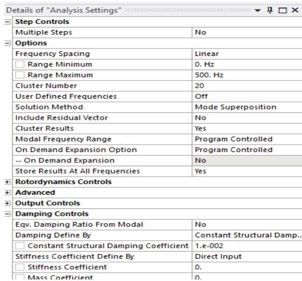
Slika 7.11. Postavke za provedbu analize
