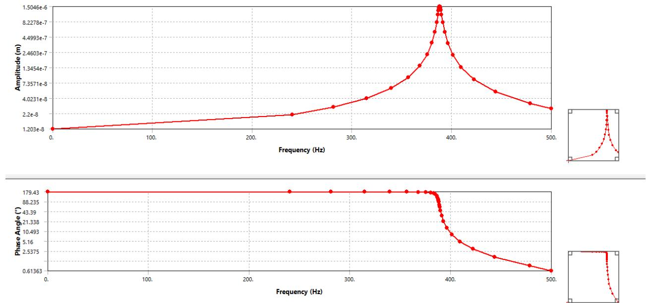
Slika 7.12. Ovisnost frekvencije s amplitudom i faznim kutom
