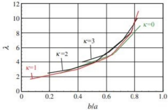
Slika 2.8. Ovisnost  $\lambda$  o omjeru polumjera  $b/a$  [3]
