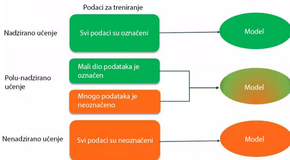
Slika 2.3. Nadzirano naspram nenadziranog i polunadziranog strojnog učenja [12]
