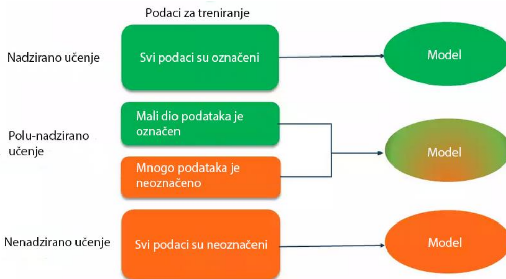
Slika 2.3. Nadzirano naspram nenadziranog i polunadziranog strojnog učenja [12]
