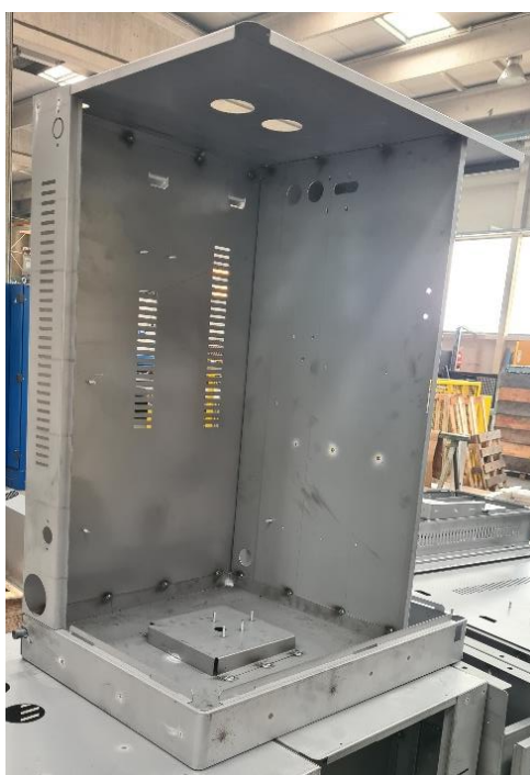
Slika 3.15. Montaža pozicija u sklop zavarivanjem
