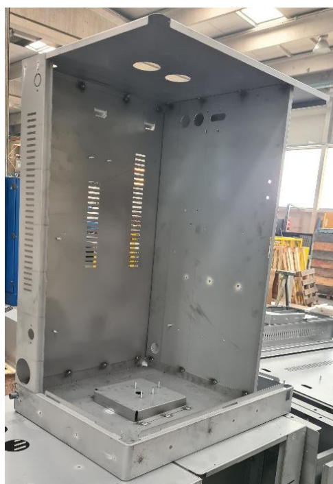
Slika 3.15. Montaža pozicija u sklop zavarivanjem
