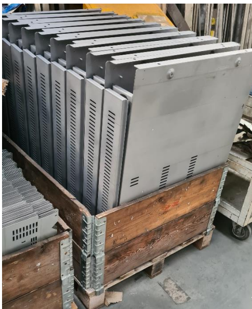
Slika 3.13. Pozicije nakon savijanja
