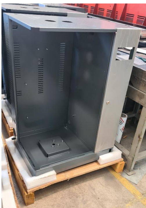
Slika 3.16. Sklop kućišta nakon elektrostatskog praškastog farbanja
