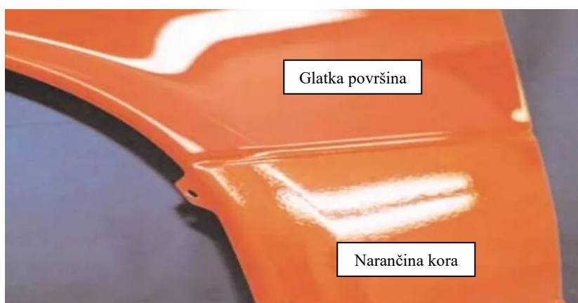
Slika 2.5. Usporedba glatke površine i narančine kore [20]
