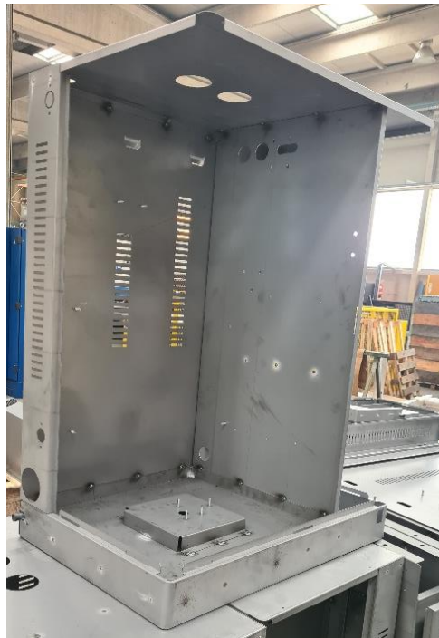
Slika 3.15. Montaža pozicija u sklop zavarivanjem
