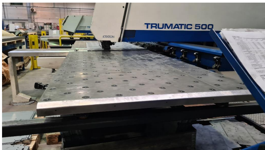
Slika 3.12. Probijanje na stroju TC-500
