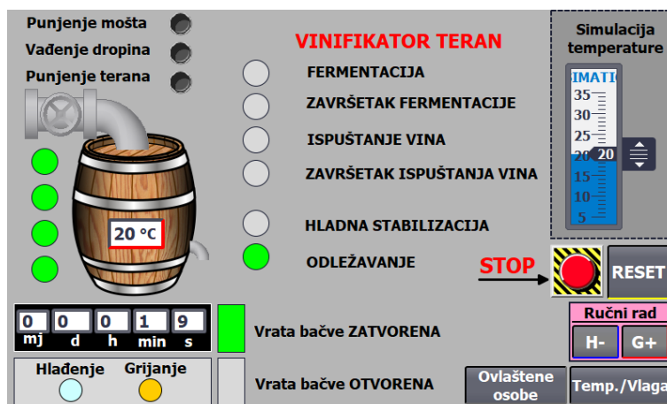
Slika 8.16 Prikaz zaslona Vinifikator teran bačva (primjer 5).
