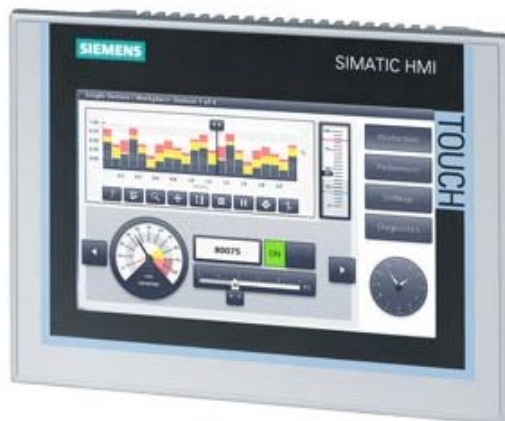
Slika 7.15 HMI touch panel 7“.
