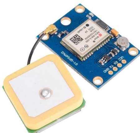
Slika 3.3 Prikaz NEO-6M GPS modula
