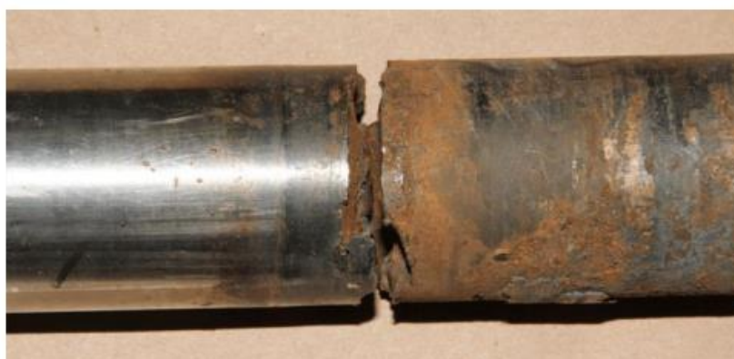
Slika 3.16 Lom vratila nastao kao posljedica korozijskog zamora u morskoj vodi [8]
