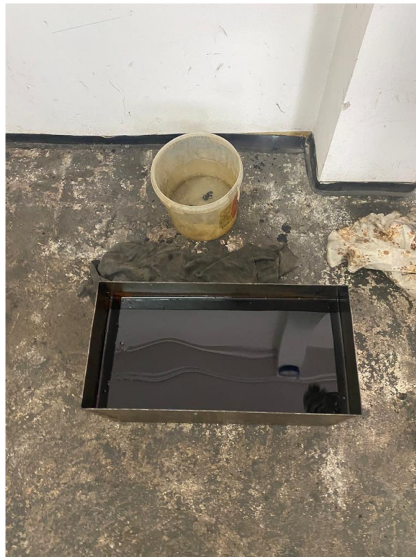
Slika 5.4 Ulje za gašenje uzoraka čelika
