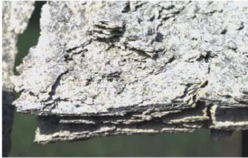
Slika 3.7 Eksfolijacija aluminijeve legure [8]
