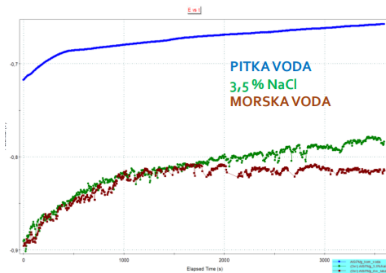
Slika 2.10 Krivulje potencijala otvorenog strujnog kruga AlSi7Mg u različitim elektrolitima [6]
