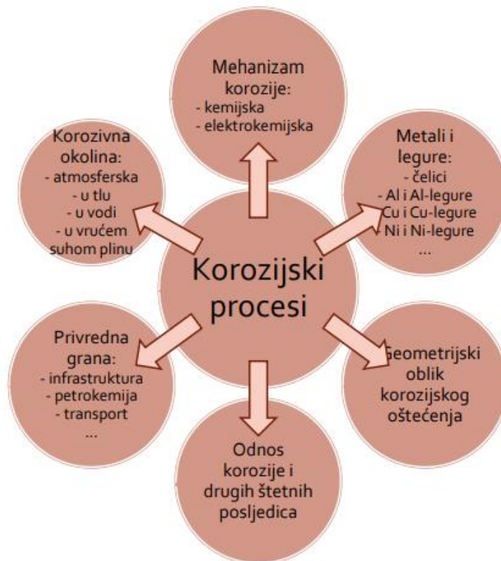
Slika 2.3 Klasifikacija korozijskih procesa [2]
