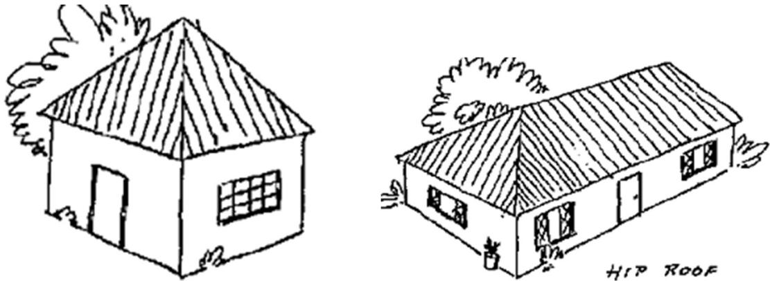
Slika 3.3. Simetrični (lijevo) i polusimetrični (desno) četverostrani krov [8]
