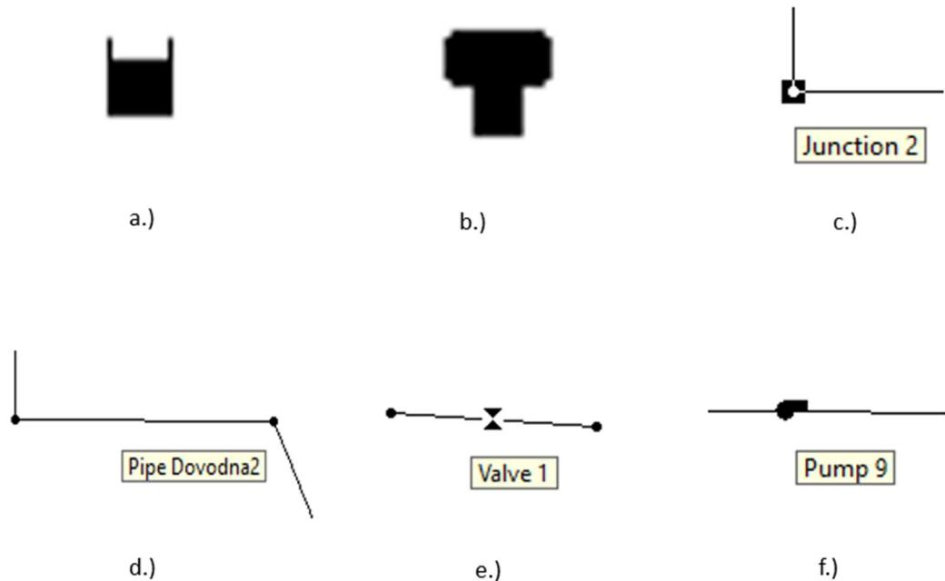
Slika 5.1. Komponente cjevovoda u Epanetu: a.) otvoreni spremnik (rezervoar), b.) zatvoren spremnik, c.) čvor; d.) cijev, e.) ventil, f.) crpka
