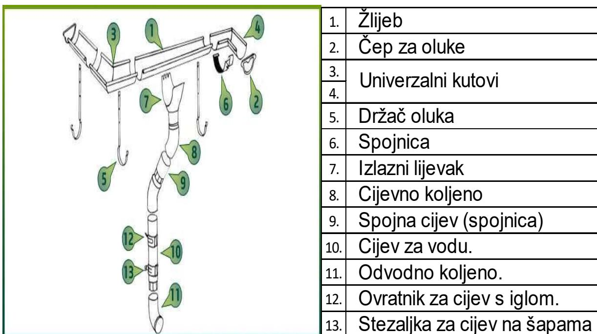
Slika 3.5. Raščlanjeni sustav dovodnih cijevi [10]
