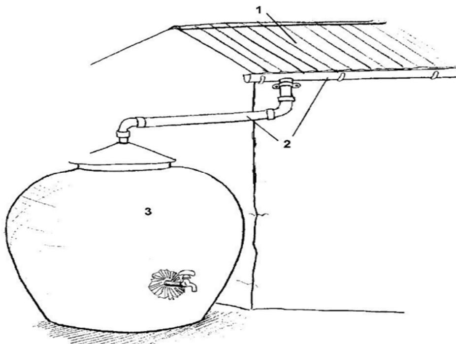
Slika 3.1. Sustav za rekuperaciju kišnice; 1- Prikupna površina, 2- cijevi za dovod do spremnika, 3 spremnik [7]
