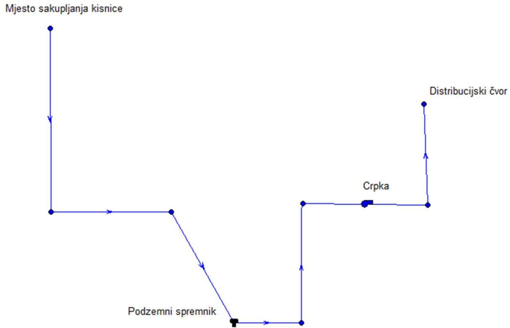
Slika 5.6. Kompletirana shema sustava izrađena u epanetu
