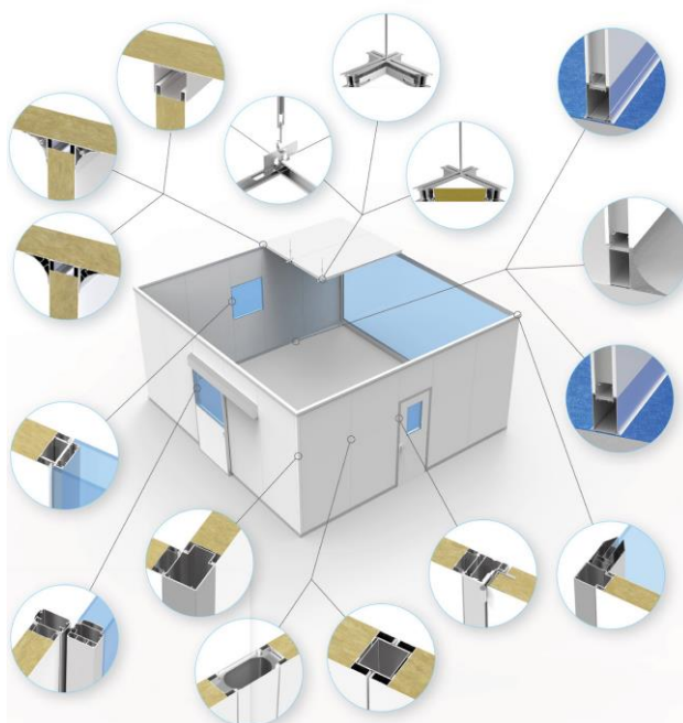
Slika 2.3. Prikaz montiranog modularnog panelnog sustava [1]
