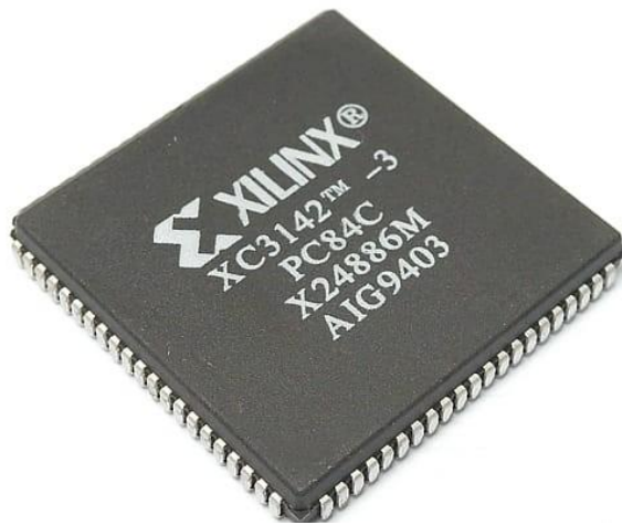
Slika 2.1. Primjer modernog FPGA čipa u SMD izvedbi.
