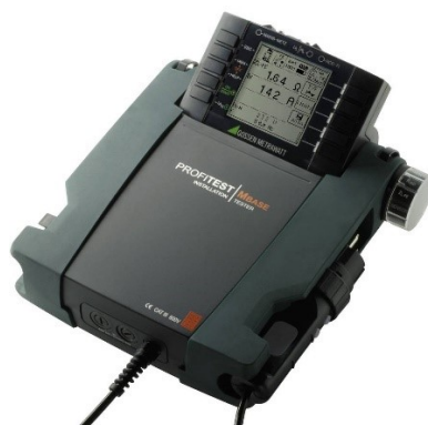
Slika 7.9. Mjerni uređaj Gossen Metrawatt, tip Profitest MBASE [14]
