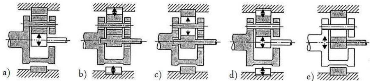
Slika 2.6. Principijelne mogućnosti izjednačavanja prijenosa opterećenja [2]
