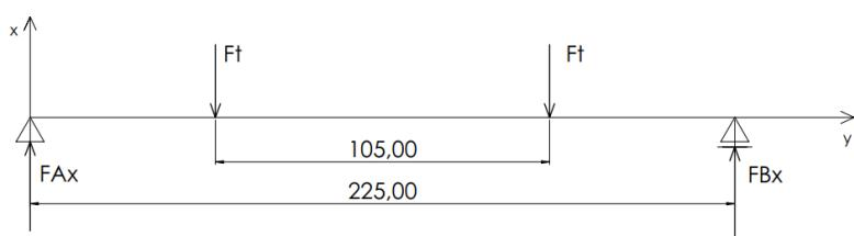
Slika 5.2. Sile na osovinu planeta prvog stupnja prijenosa
