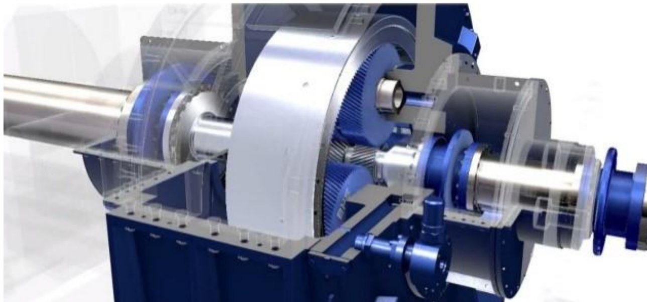
Slika 3.4. Osnovni elementi planetnog prijenosnika proizvođača „VOITH“ [23]
