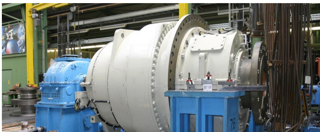
Slika 3.3. Planetni prijenosnik proizvođača „RENK“ [22]
