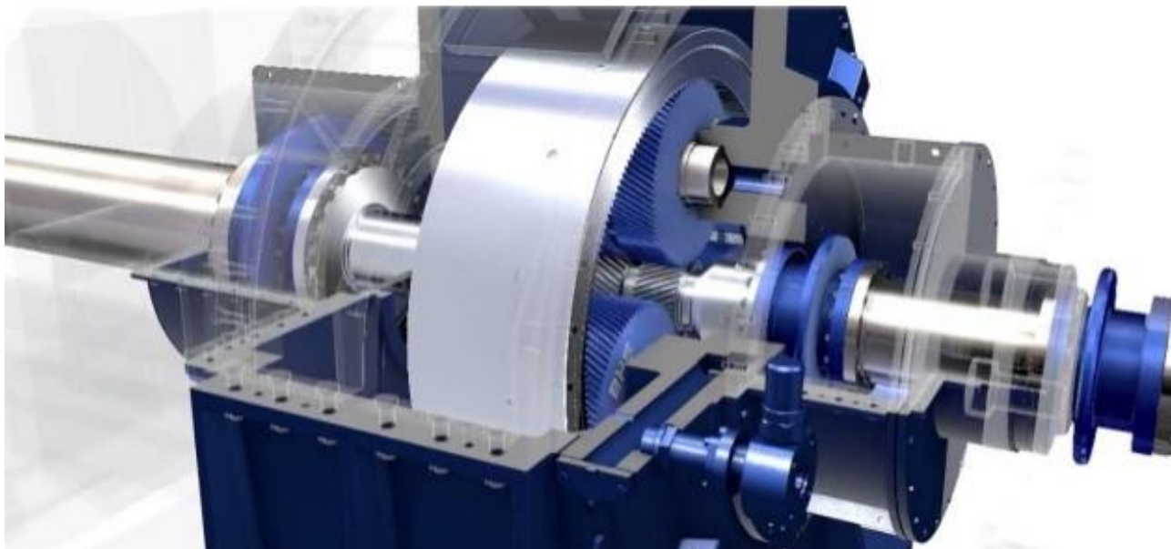
Slika 3.4. Osnovni elementi planetnog prijenosnika proizvođača „VOITH“ [23]
