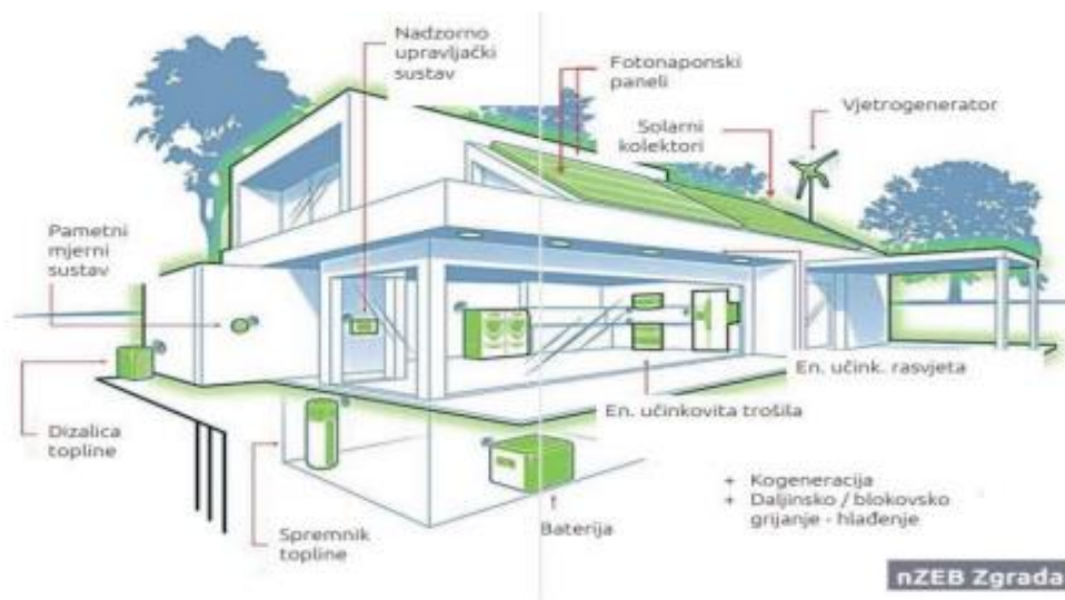
Slika 2.1 – Primjer nZEB zgrade [9]
