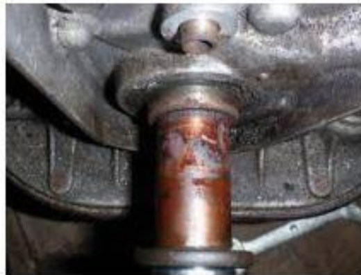
Slika 2.25.: Primjer oštećenja nastao tarnom korozijom [3]
