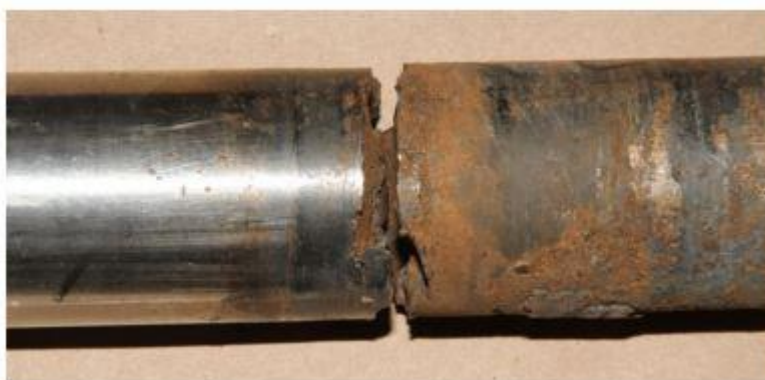
Slika 2.24.: Lom vratila uslijed korozijskog zamora [3]
