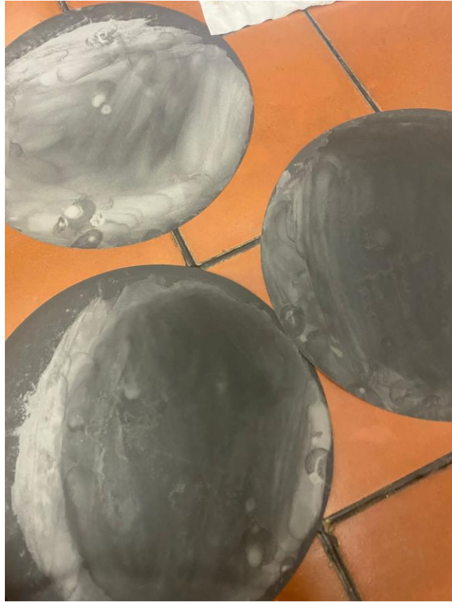
Slika 4.1.: Korišteni brusni papiri za postizanje glatke površine uzorka
