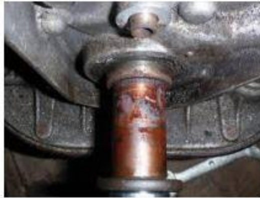
Slika 2.25.: Primjer oštećenja nastao tarnom korozijom [3]
