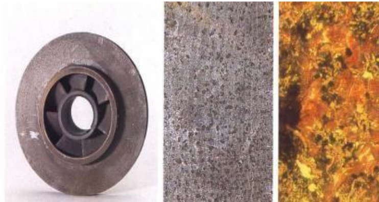
Slika 2.20.: Primjer grafitizacije čelika [11]
