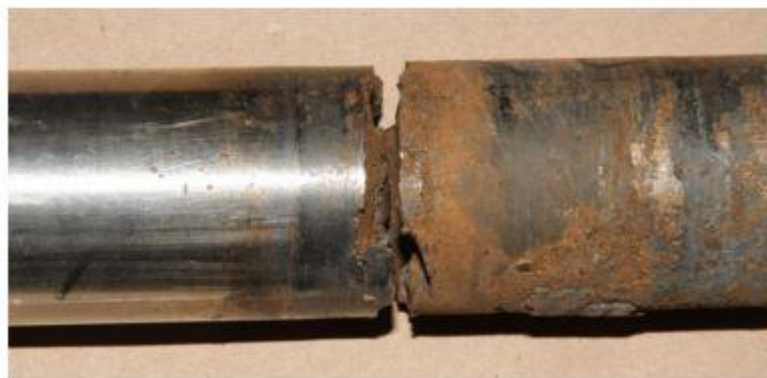
Slika 2.24.: Lom vratila uslijed korozijskog zamora [3]
