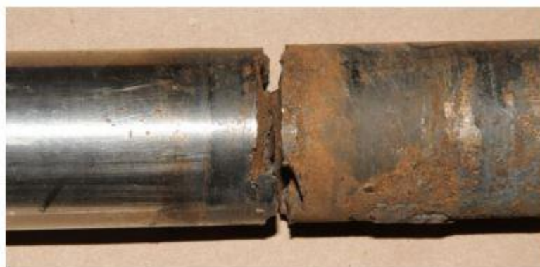
Slika 2.24.: Lom vratila uslijed korozijskog zamora [3]
