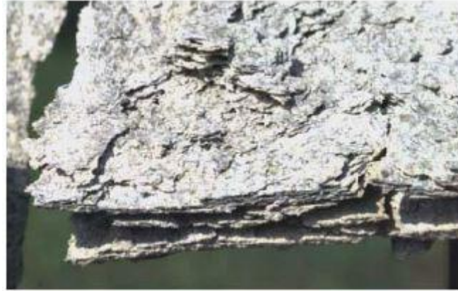
slika 2.15.: Eksfolijacija Al-legure u morskoj atmosferi [3]
