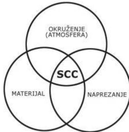
Slika 2.23.: Čimbenici koji utječu na pojavu napetosne korozije [12]
