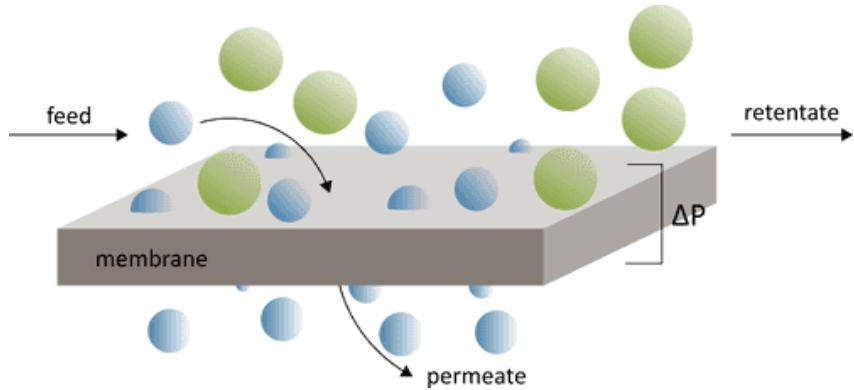
Slika 3.2 Princip rada membranske filtracije [16]
