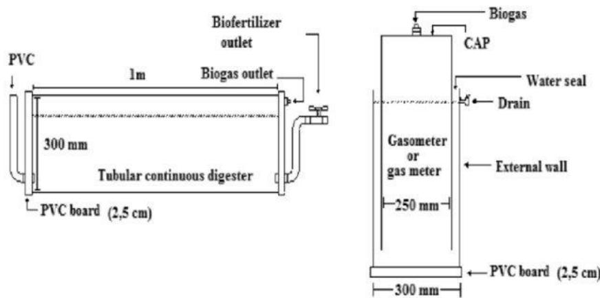
*Slika 6.4 Horizontalni kontinuirani digestor*
