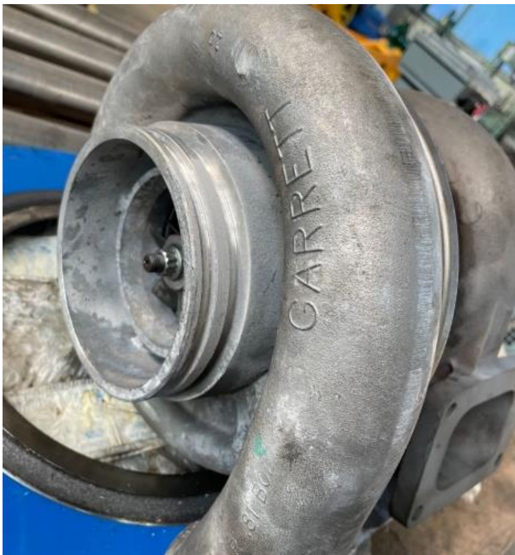
Slika 6.7 Turbopuhalo motora Waukesha H24GL [autor]
