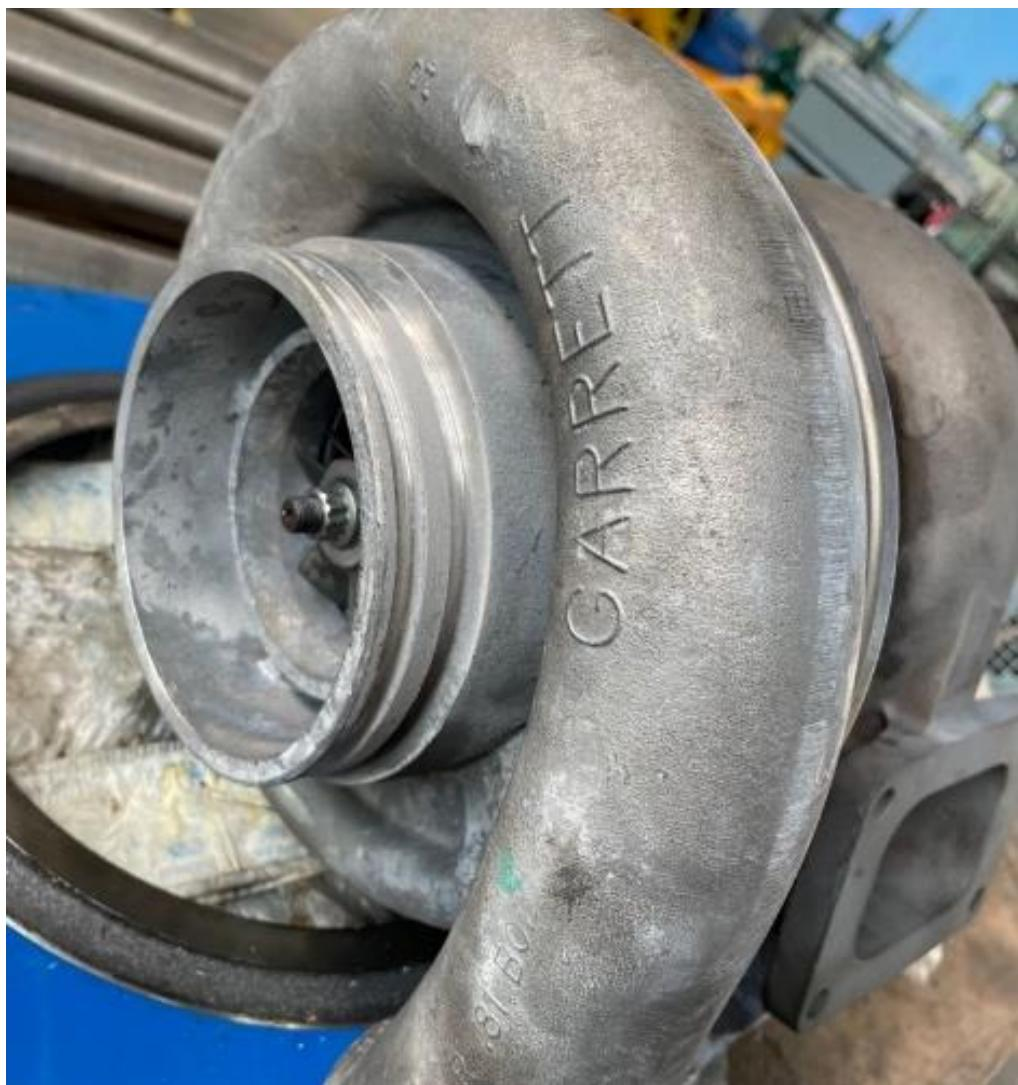
Slika 6.7 Turbopuhalo motora Waukesha H24GL [autor]
