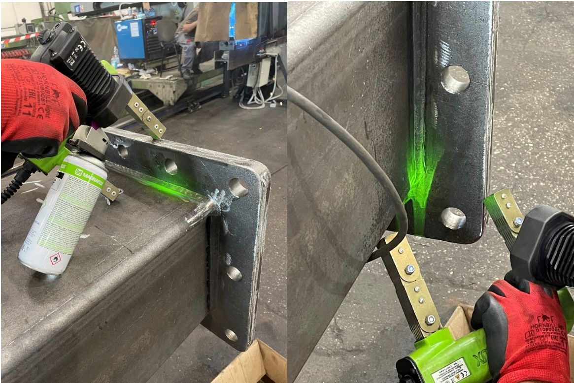
Slika 9.8. Ispitivanje fluorescentnim magnetskim česticama
