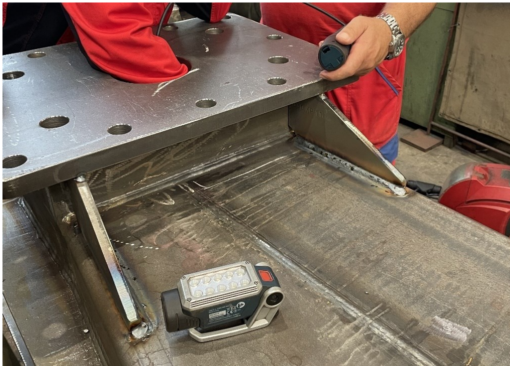
Slika 9.5 Vizualna inspekcija unutarnje strane zavara korištenjem videoskopa „BOSCH Professional GIC 120“
