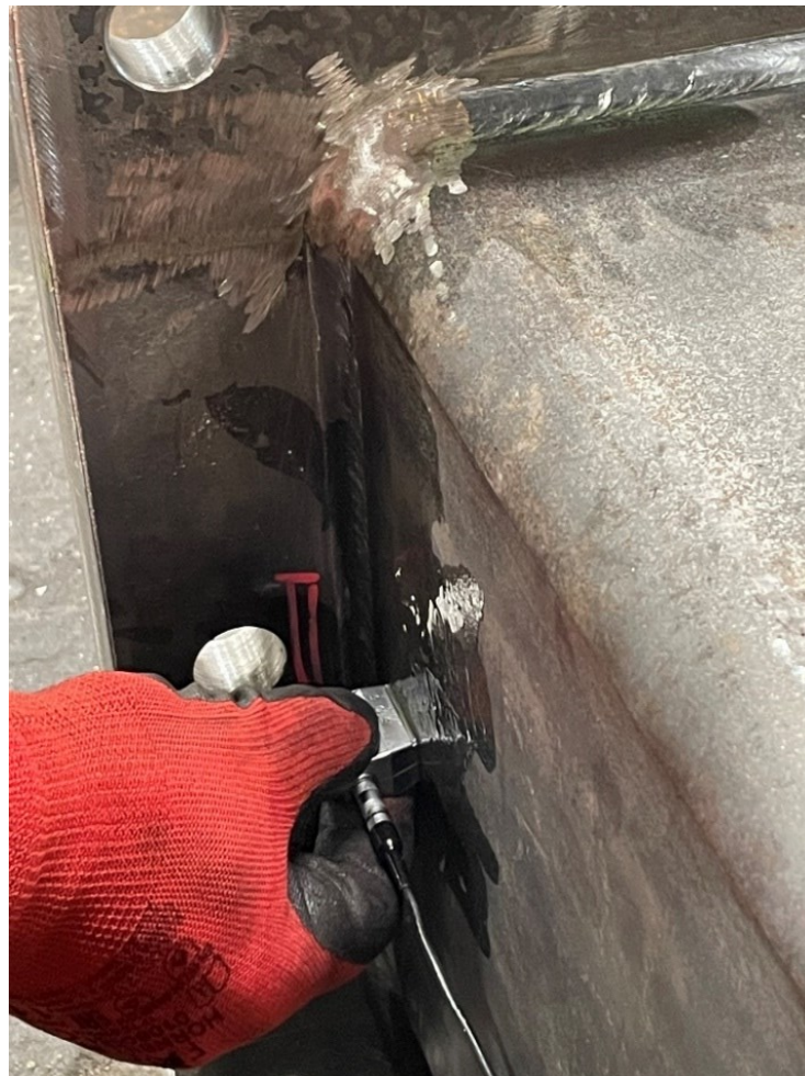
Slika 9.9. Kutno skeniranje zavarenog spoja
