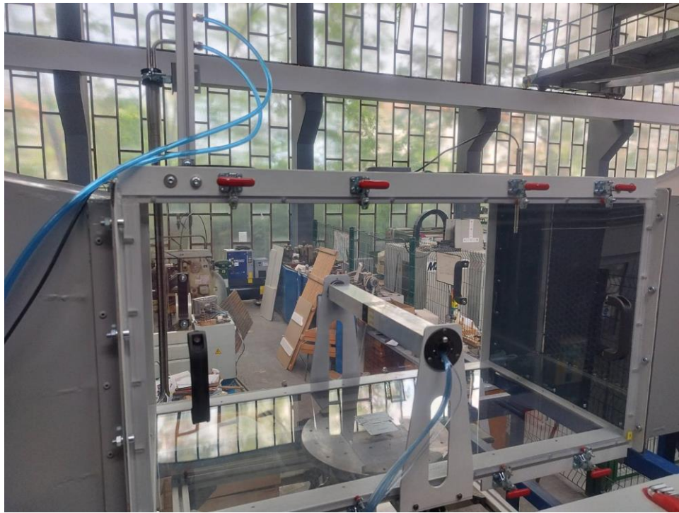
Slika 6.7 Pozicija Hot Wirea (desno od kvadra) i Pitota (lijevo od kvadra) u testnoj sekciji
