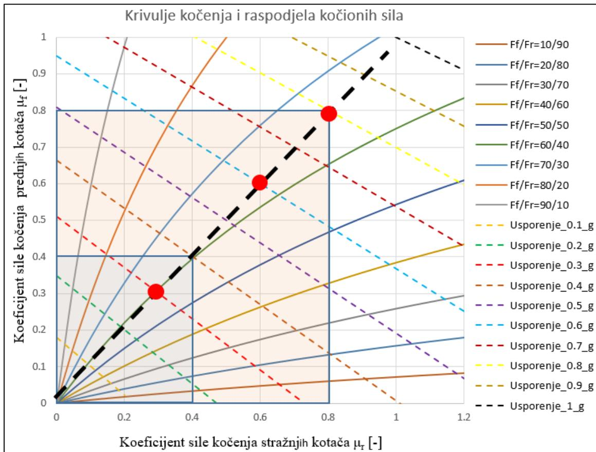
Slika 4.5. Krivulje kočenja i raspodjela kočionih sila pri bezdimenzijskim opterećenjem na kotačima
