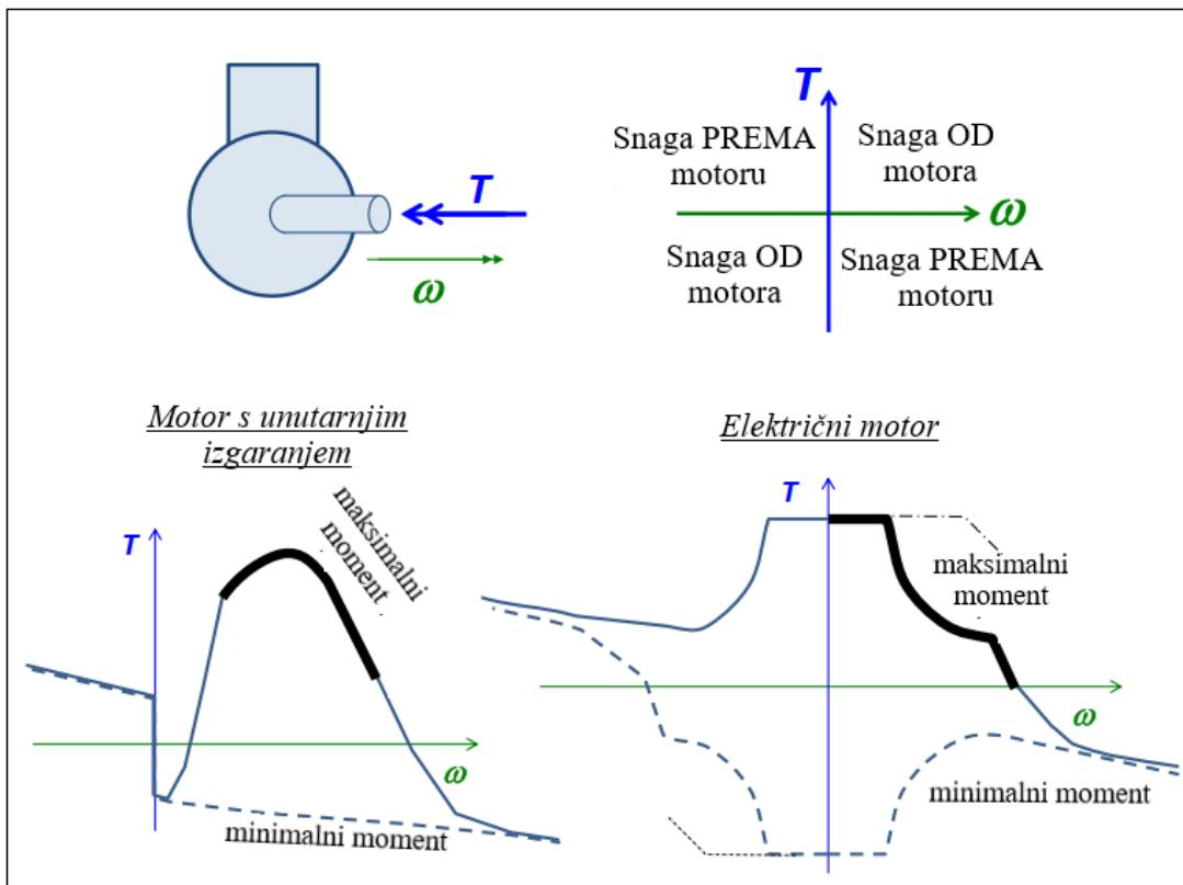
Slika 2.3 Momentne karakteristike primarnih pogonskih sustava [Jacobsen, 2015., str. 85]
