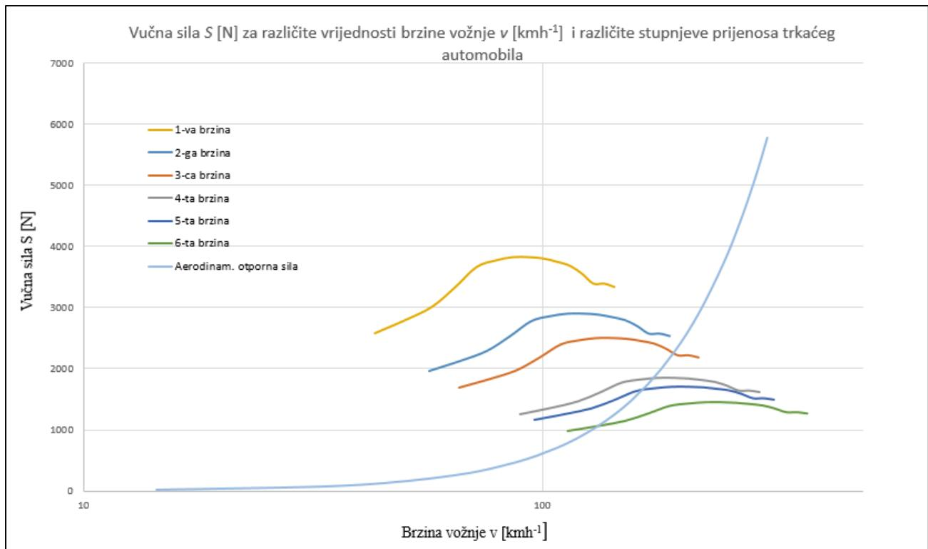
Slika 4.3. Dijagram vučnih sila po stupnjevima prijenosa
