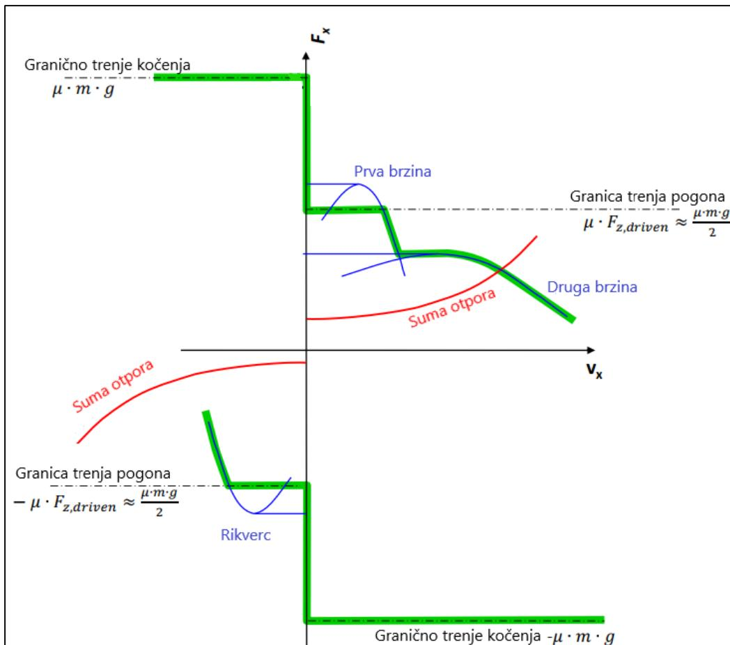
Slika 3.7 Dijagram prijanjanja s maksimalnom i minimalnom pogonskom silom
