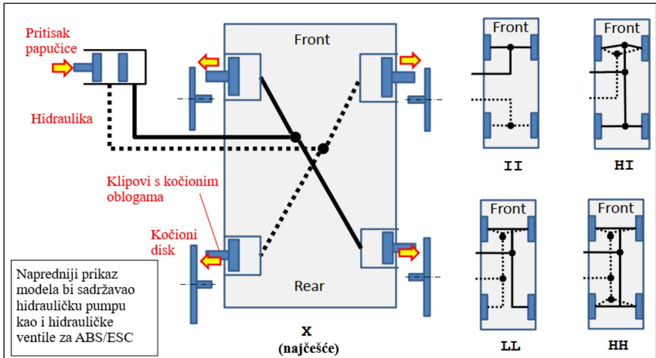
Slika 3.8. Hidraulički sustav kočenja u vozilima [Jacobsen, 2015., str. 111]
