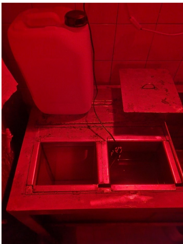
Slika 5.18. Spremnici razvijачa i fiksira
