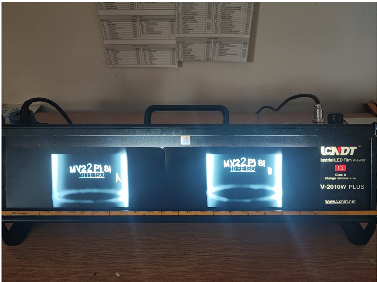
Slika 5.20. Iluminator sa filmovima strojnog dijela MV.22 – PI.81
