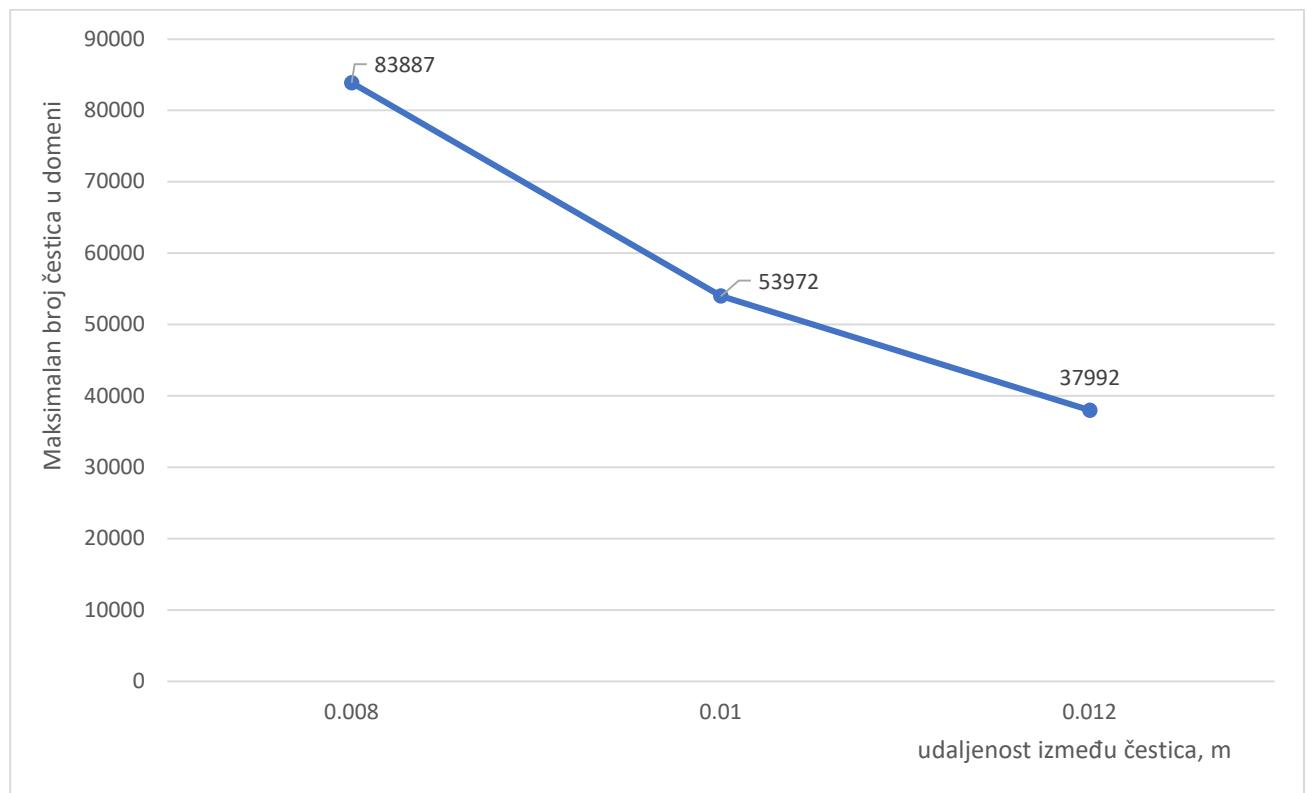
*Slika 7.14 Promjena maksimalnog broja čestica u domeni u ovisnostio dp za slučaj turbulentnog strujanja oko cilindra kvadratnog poprečnog presjeka*
