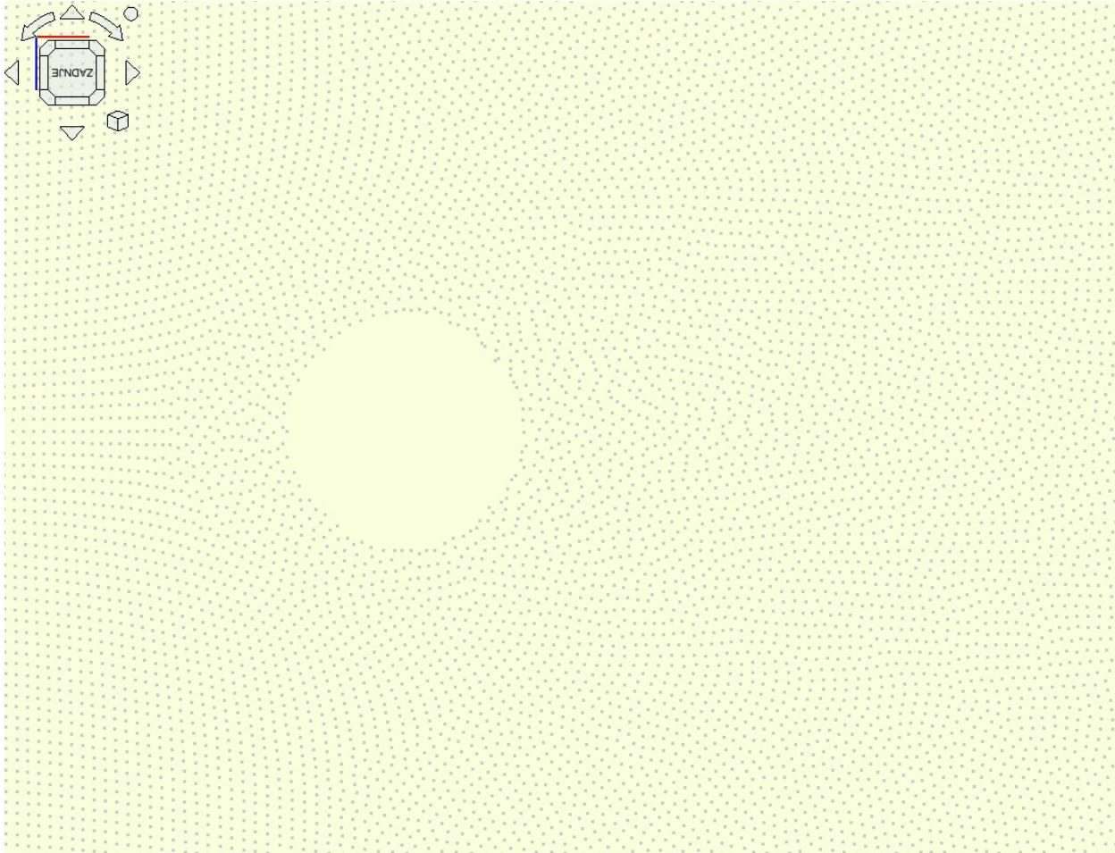
*Slika 7.2 Raspored čestica oko cilindra kružnog poprečnog presjeka*
