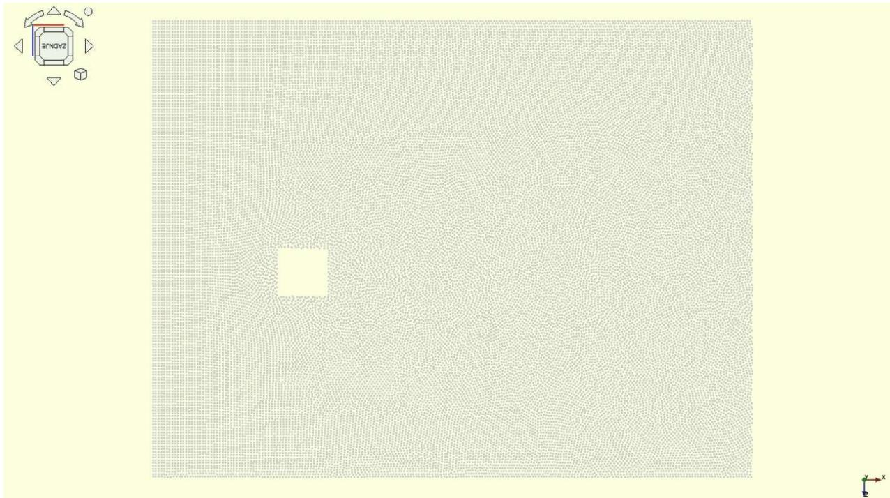
Slika 7.9 Domena ispunjena česticama za slučaj strujanja fluida oko cilindra kvadratnog poprečnog presjeka
