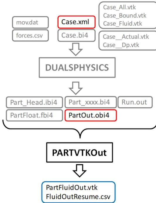
*Slika 3.6 Shematski prikaz procesa poslije procesiranja za vizualizaciju izlaznih podataka o česticama koje su isključene iz simulacije<sup>2</sup>*
