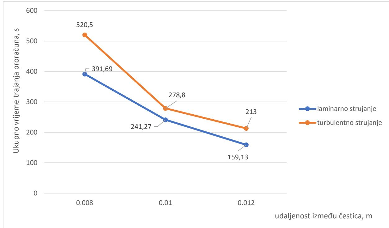
*Slika 7.17 Promjena ukupnog vremena trajanja proračuna u ovisnosti o dp za slučaj turbulentnog i laminarnog strujanja oko cilindra*
