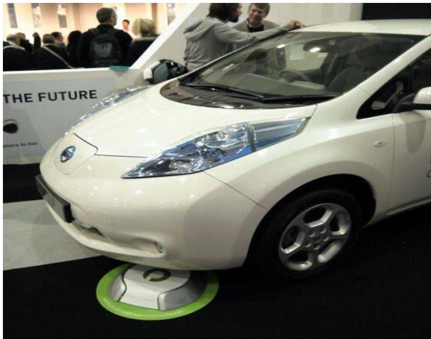
Slika 3.2. Induktivno punjenje električnog vozila [13]
