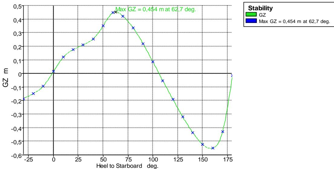
Slika 12.4. Poluga stabiliteta za vodomlazni pogonski sustav za stanje krcanja  $M_{LA}$
