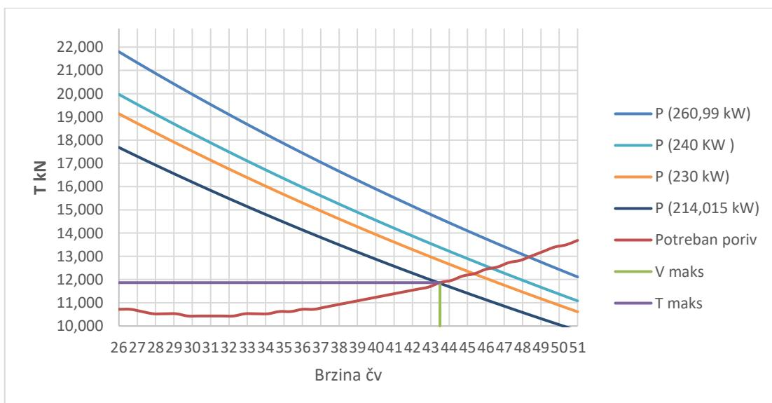
Slika 10.4. Porivi vodomlaznih propulzora dobiveni iteracijskim putem
