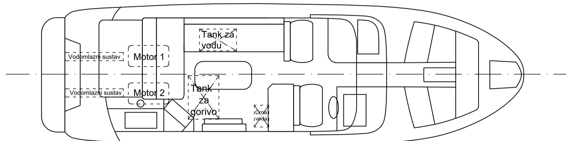
IZVEDBA 1. - S VODOMLAZNIM PROPULZORIMA -
