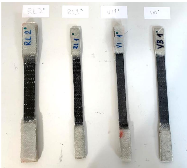
Slika 6.39. Testni uzorci tab-ova prije testiranja
