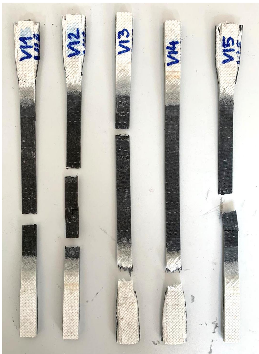
Slika 6.56. Uzorci izrađeni vakuumskim infuzijskim postupkom nakon testiranja
