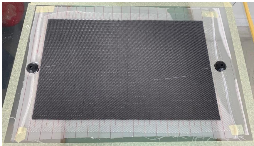
Slika 6.18. Prikaz finalnog laminata izrađenog vakuumskom infuzijom
