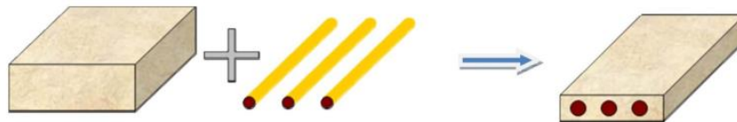
Slika 2.1. Skica kompozitnog materijala [8]
