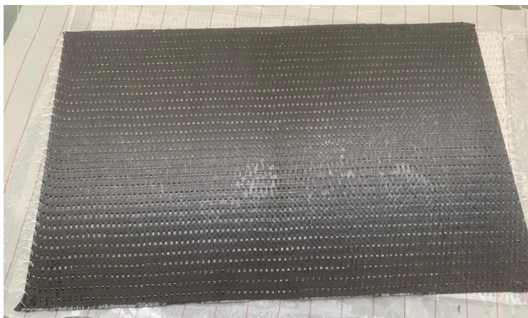
Slika 6.12. Izgled završnog laminata izrađenog vakuumiranjem mokrog laminata nakon sušenja smole
