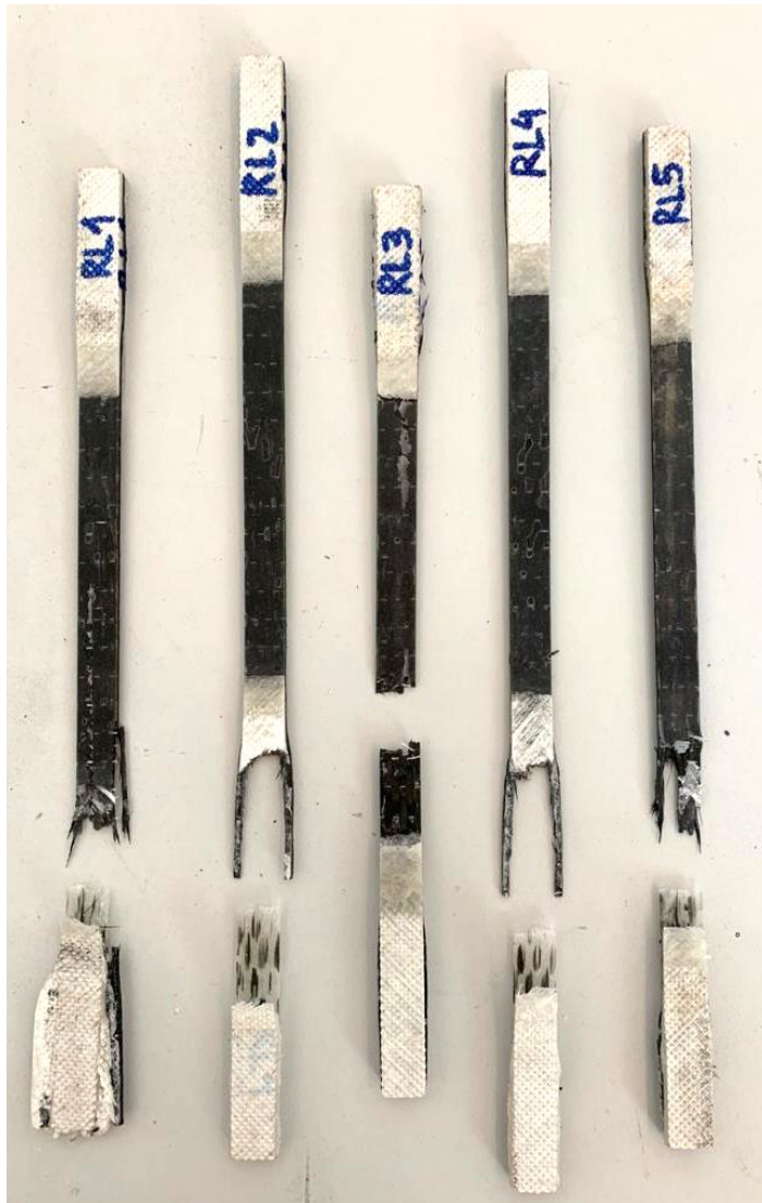
Slika 6.42. Uzorci izrađeni ručnim dodirnim postupkom nakon testiranja
