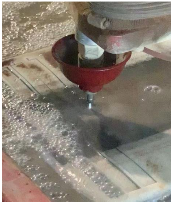
Slika 6.22. Prikaz rezanja vodenim mlazom iz bliza
