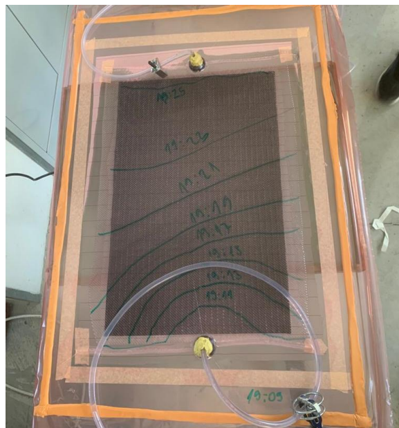
Slika 6.17. Prikaz oznaka pomaka smole po vremenu od početka do kraja vakuumskog infuzijskog postupka
