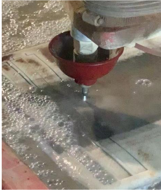
Slika 6.22. Prikaz rezanja vodenim mlazom iz bliza
