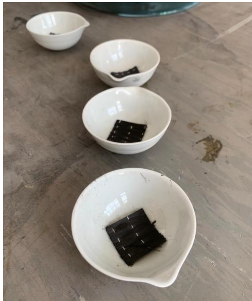
Slika 6.29. Uzorci u posudicama nakon izgaranja smole
