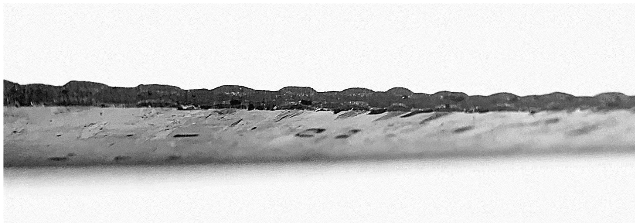
Slika 7.2. Presjek uzorka ručnog dodirnog postupka iz bliza
