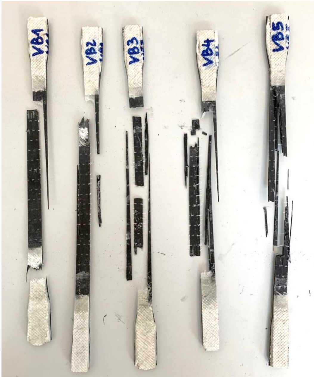
Slika 6.49. Uzorci izrađeni postupkom vakuumiranja mokrog laminata nakon testiranja
