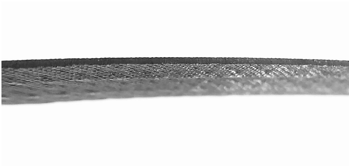
Slika 7.4. Presjek uzorka izrađenog vakuumskim infuzijskim postupkom iz bliza
