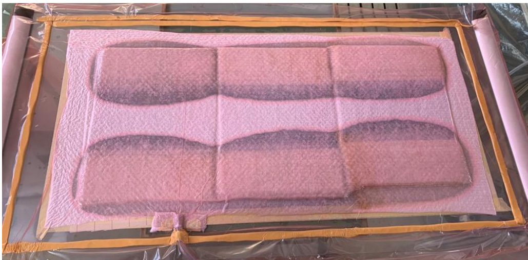
Slika 6.19. Prikaz izrade zadebljanja na laminatima (svaka ploča predstavlja laminat izrađen jednom metodom laminiranja)
