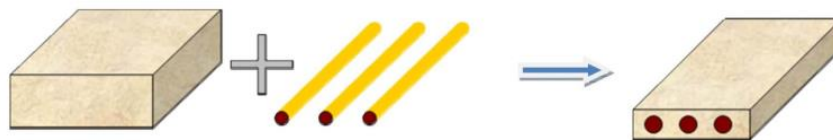
Slika 2.1. Skica kompozitnog materijala [8]
