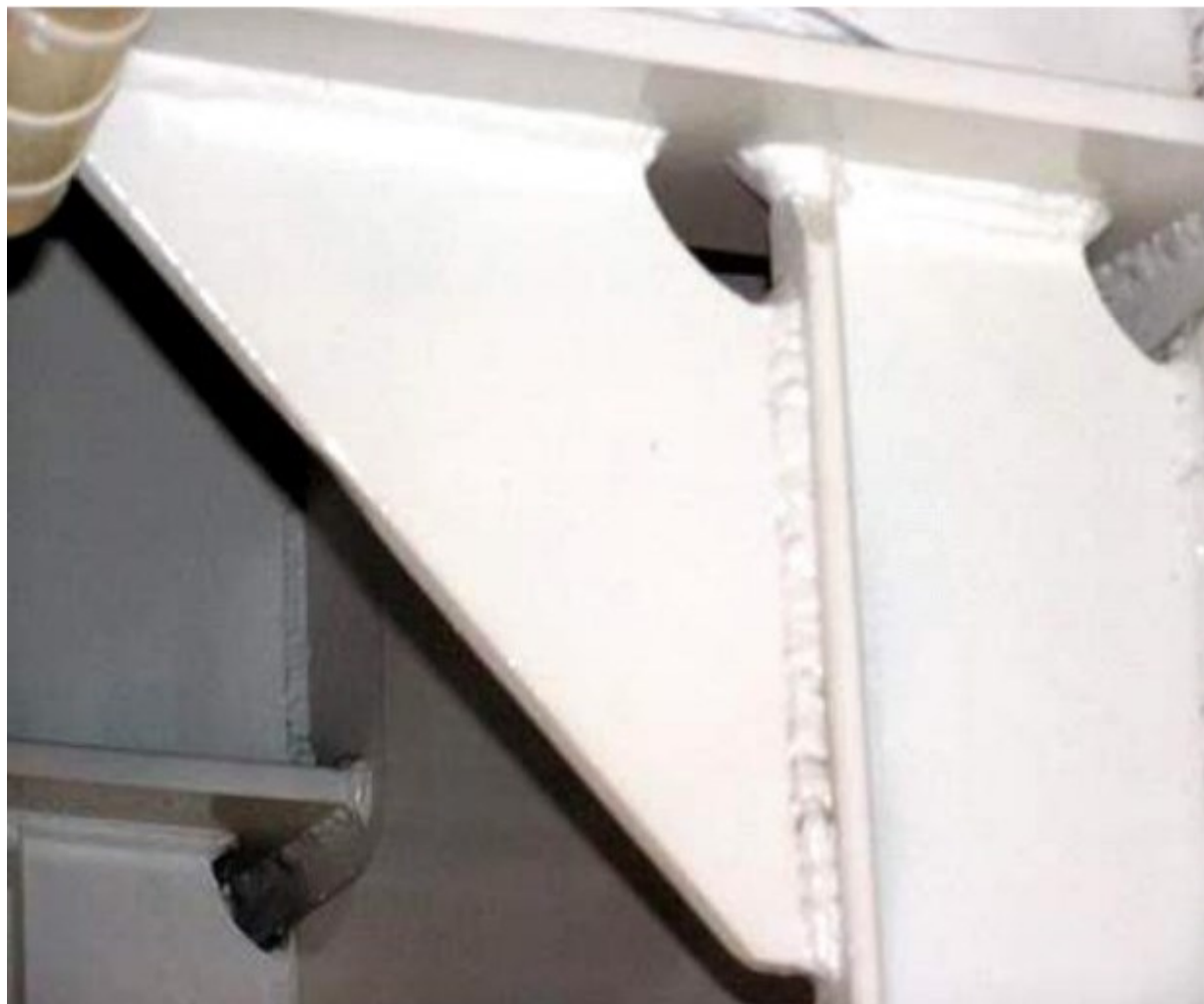
Slika 5.1. Koljeno u strukturi broda[4]
