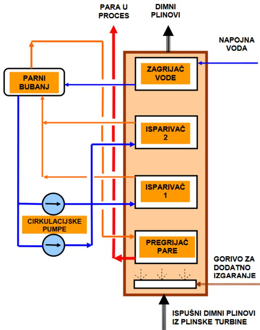
Slika 3.9 Shema utilizatora[14]
