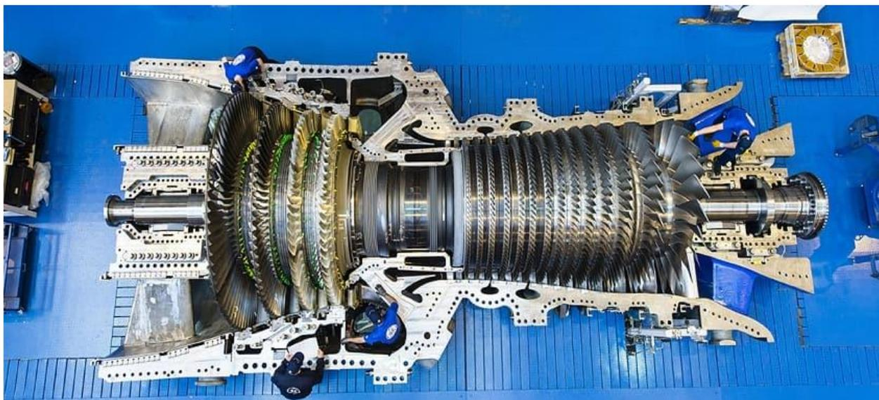
Slika 3.2 Presjek plinske turbine[6]
