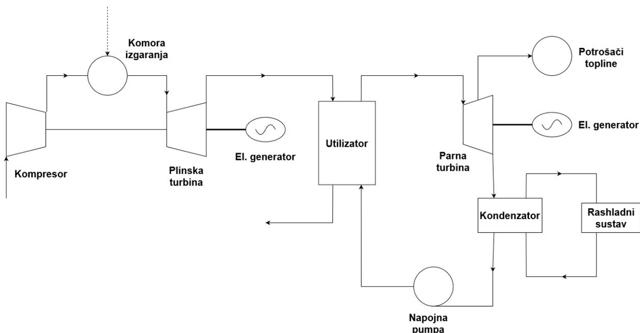
Slika 3.1 Pojednostaljeni shematski prikaz kombiniranog kogeneracijskog postrojenja
