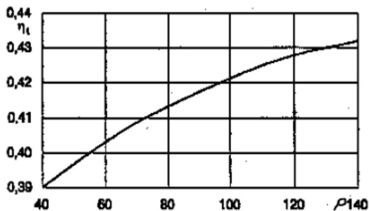
Slika 4.3 Dijagram prikazuje ovisnost efikasnosti o tlaku[15]
