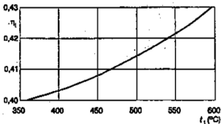
Slika 4.2 Dijagram prikazuje ovisnost efikasnosti o temperaturi[15]
