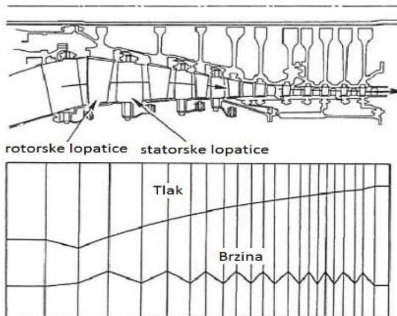
Slika 3.4 Prikaz presjeka aksijalnog kompresora sa više stupnjeva i ovisnost tlaka-brzine[10]
