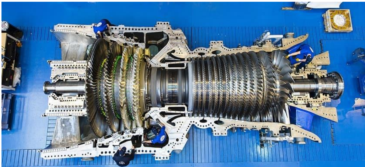
Slika 3.2 Presjek plinske turbine[6]
