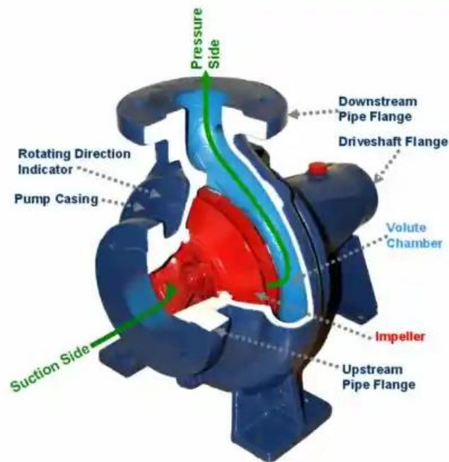
*Slika 3.15 Presjek centrifugalne pumpe i njenih dijelova[19]*
