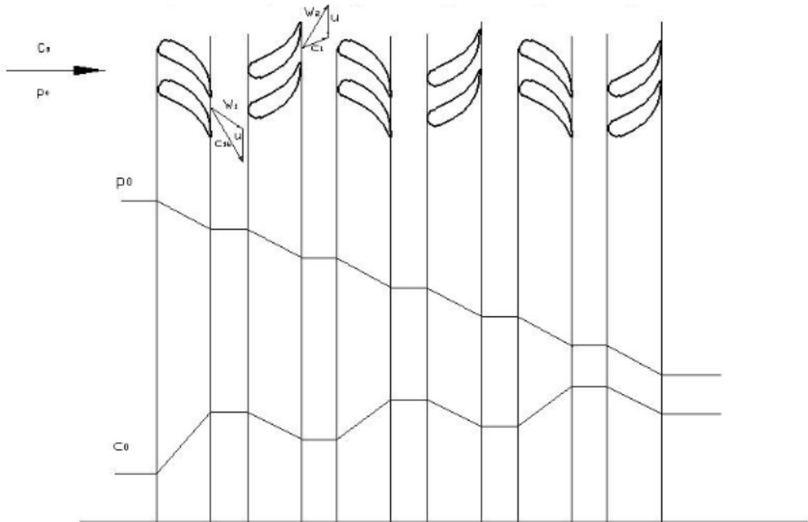
*Slika 3.7. Stupnjevanje i dijagram pada tlaka i povećanja brzine [13]*
