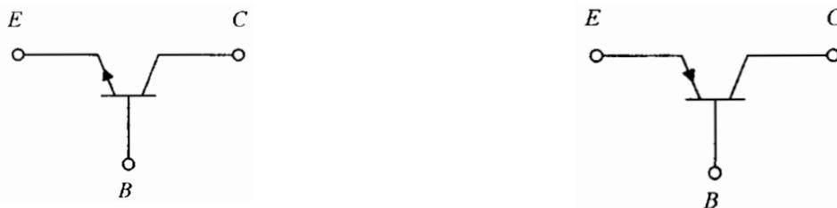
Slika 1.2.a) Simbol NPN bipolarnog tranzistora; 1.2.b) Simbol PNP bipolarnog tranzistora [6]
