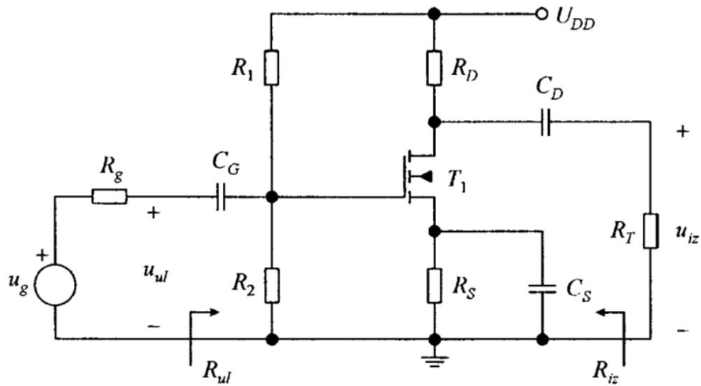
Slika 1.8. Električna shema pojačala u spoju ZS [10]
