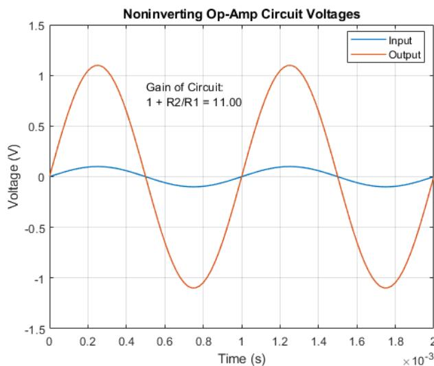
Slika 3.3. Valni oblik izlaznog napona neinvertirajućeg pojačala [20]
