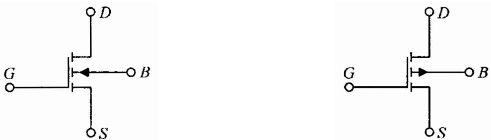
*Slika 1.3.a) N-kanalni MOSFET obogaćenog tipa; 1.3.b) P-kanalni MOSFET obogaćenog tipa [7]*
