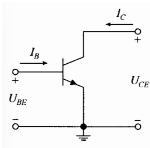
Slika 1.4. Shema bipolarnog tranzistora u spoju ZE [8]
