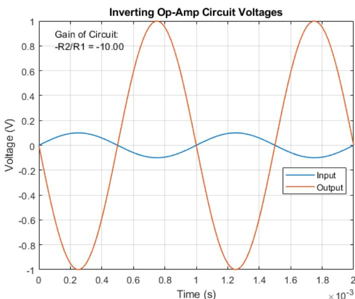
Slika 3.5. Valni oblik izlaznog napona invertirajućeg pojačala [23]
