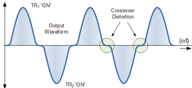
Slika 2.5. Valni oblik izlaznog signala pojačala klase B [15]
