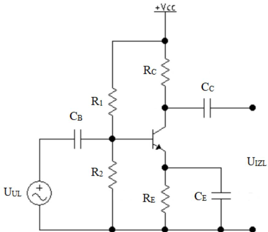
Slika 1.6. Shema pojačala u spoju ZE sa stabilizacijom staticke radne točke [Electronics Workbench]
