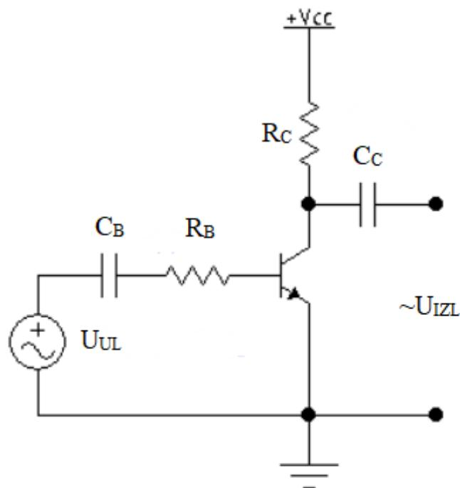
*Slika 1.5. Shema pojačala u spoju ZE sa otpornicima za postavljanje staticke radne točke [Electronics Workbench]*
