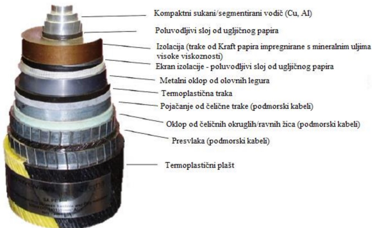
Slika 3.8. Maseni impregnirani HVDC podmorski kabel, tipične težine 30 do 60 kg/m, tipičnog promjera 110 do 140 mm [12]
