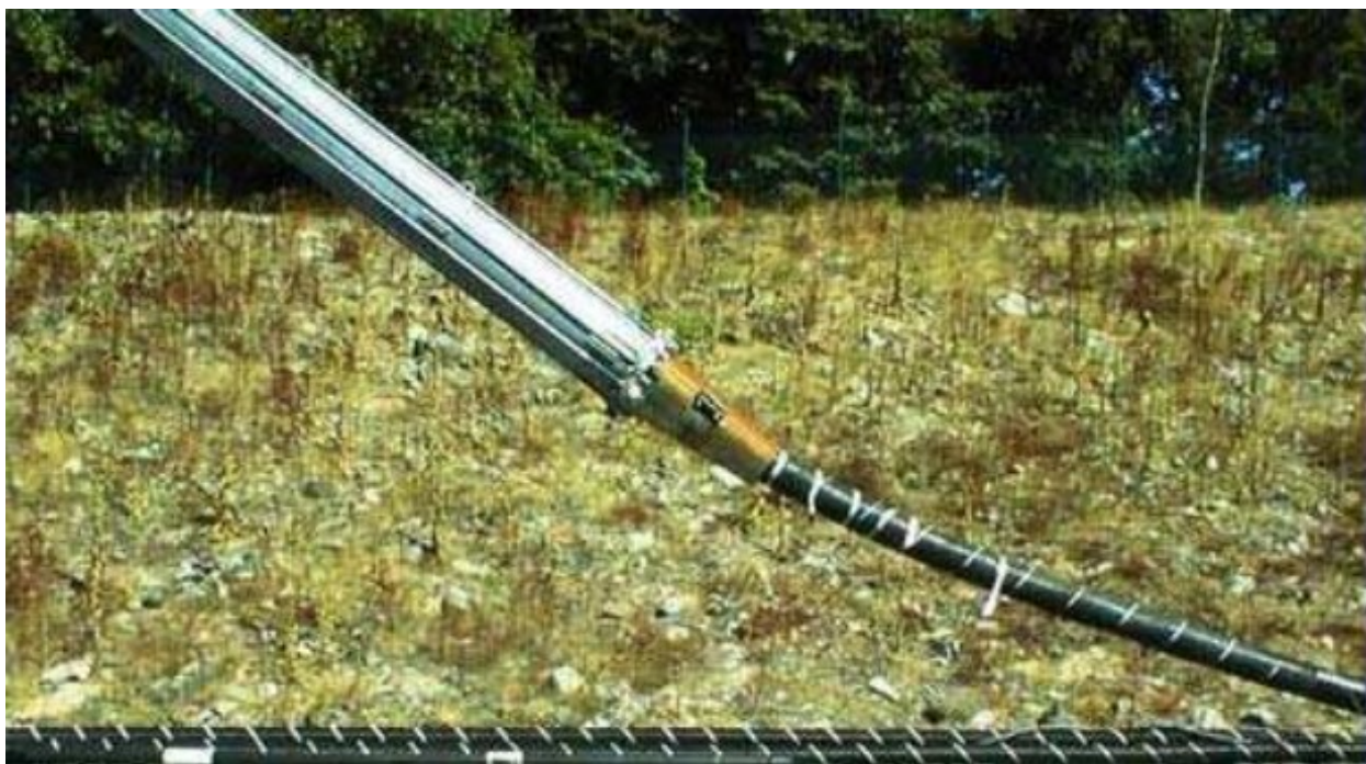
Slika 4.17. Čvrsti podmorski instalacijski spoj u čeličnom omotaču za 1F kabel tijekom testa savijanja na obali [13]
