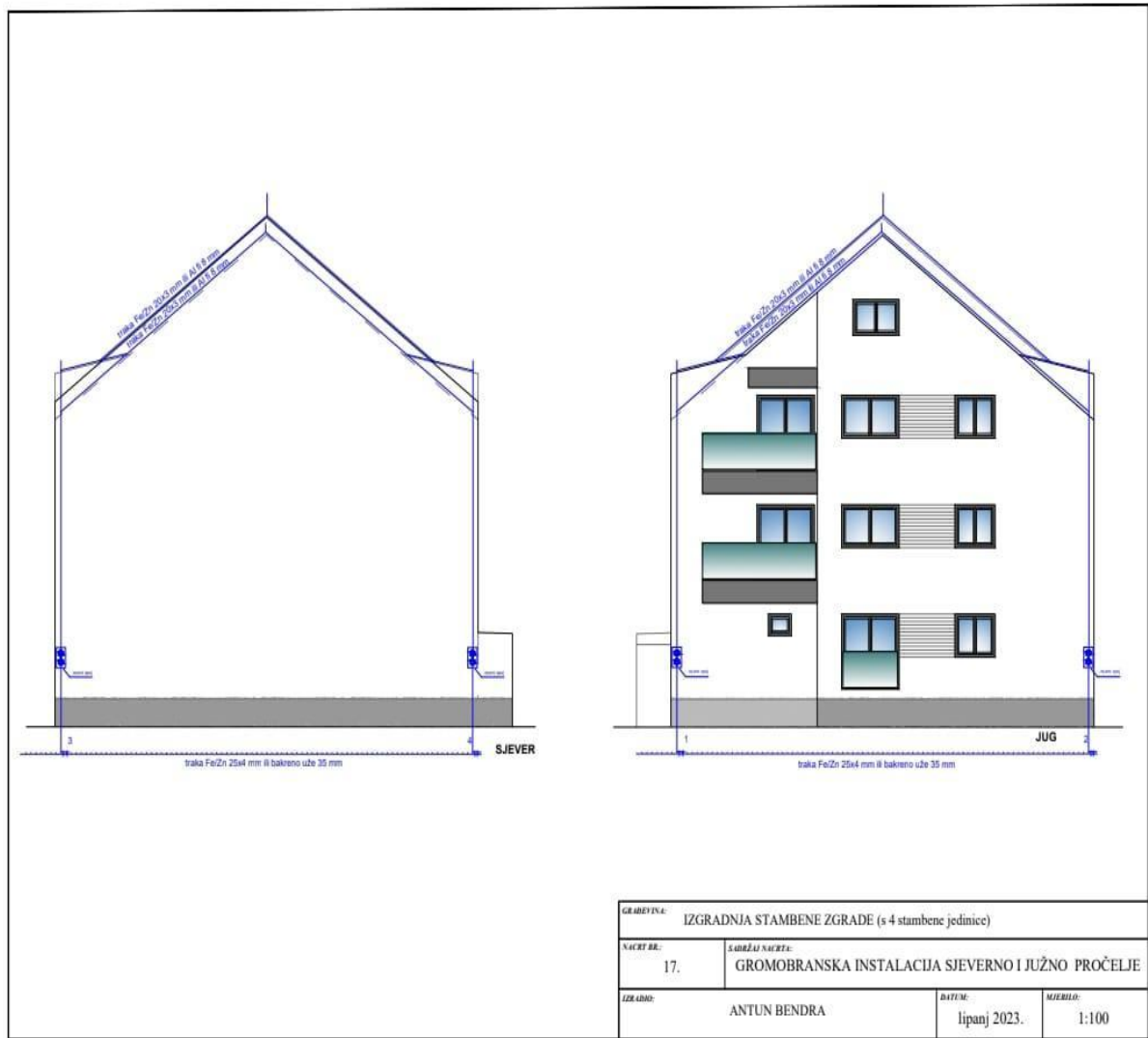
Slika 7.2 Prikaz gromobranske instalacije pročelja
