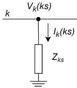
Slika 5.5 Jednofazni prikaz kratkog spoja na čvorištu  $k$
