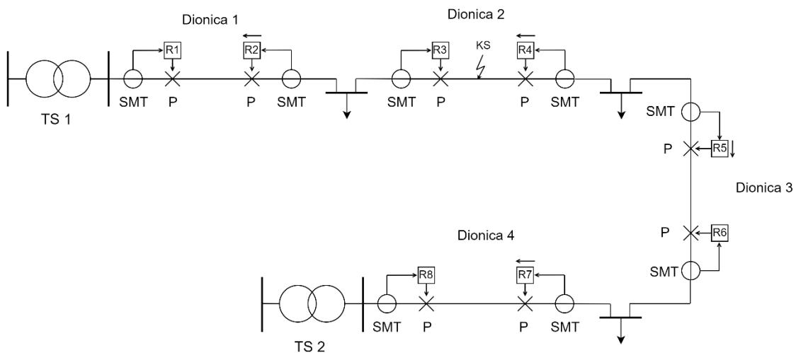
Slika 3.15 Uporaba usmjerenih releja u poveznoj distribucijskoj mreži pri paralelnom (upetljanim) pogonu oba izvoda
