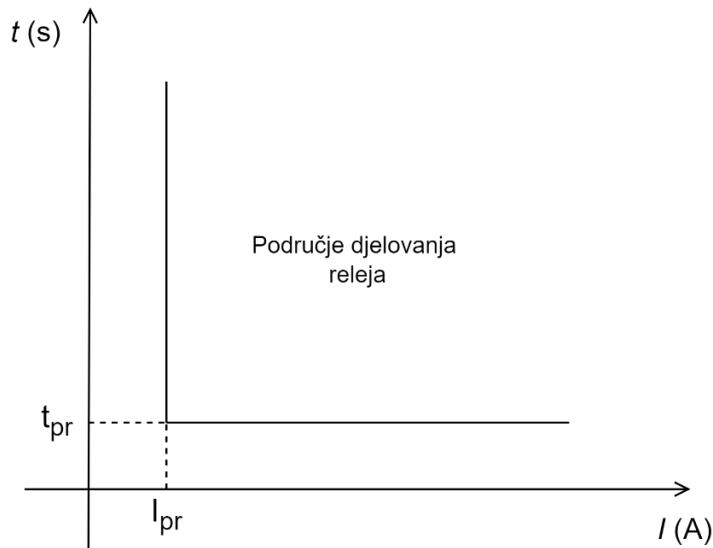
Slika 3.2 Karakteristika prorade nadstrujnog releya sa strujno-vremenskom nezavisnom karakteristikom i vremenskim zatezanjem
