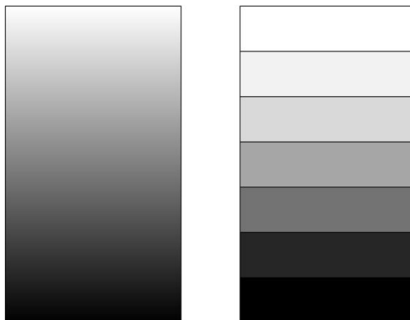
Sl. 2.2 Kontinuirana (lijevo) i stepenasta (desno) struktura FG materijala
