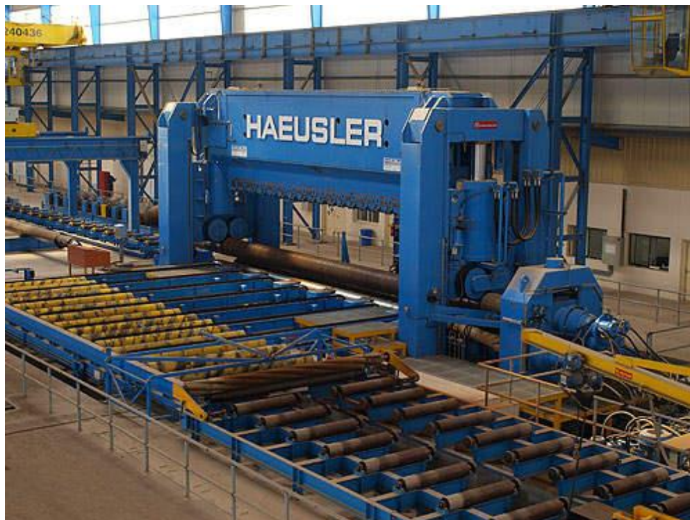
Slika 14.2 Prikaz stroja za ravnanje limova
