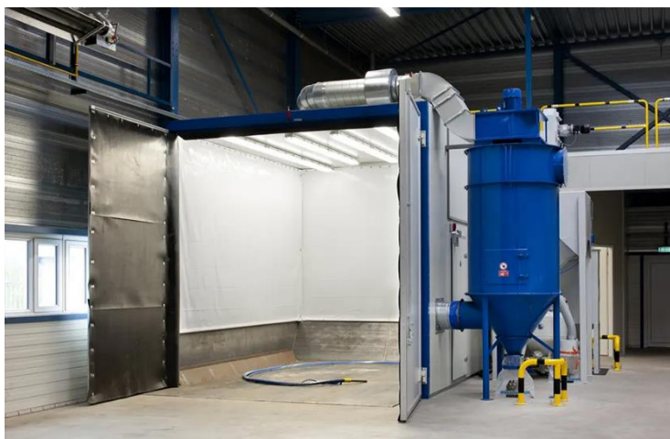
Slika 14.4 Prikaz komore za sačmarenje
