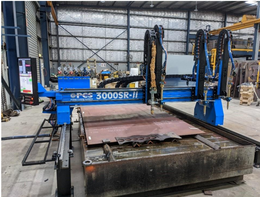
Slika 15.5 Prikaz plazma rezača
