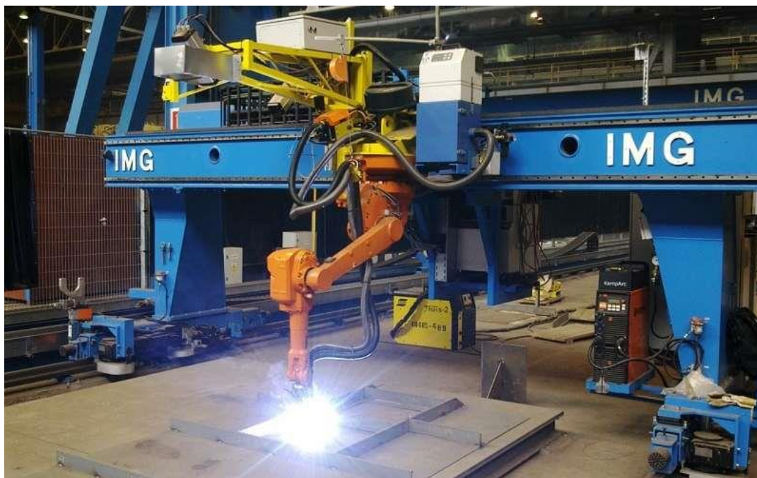
Slika 16.4 Prikaz mikropanel linije
