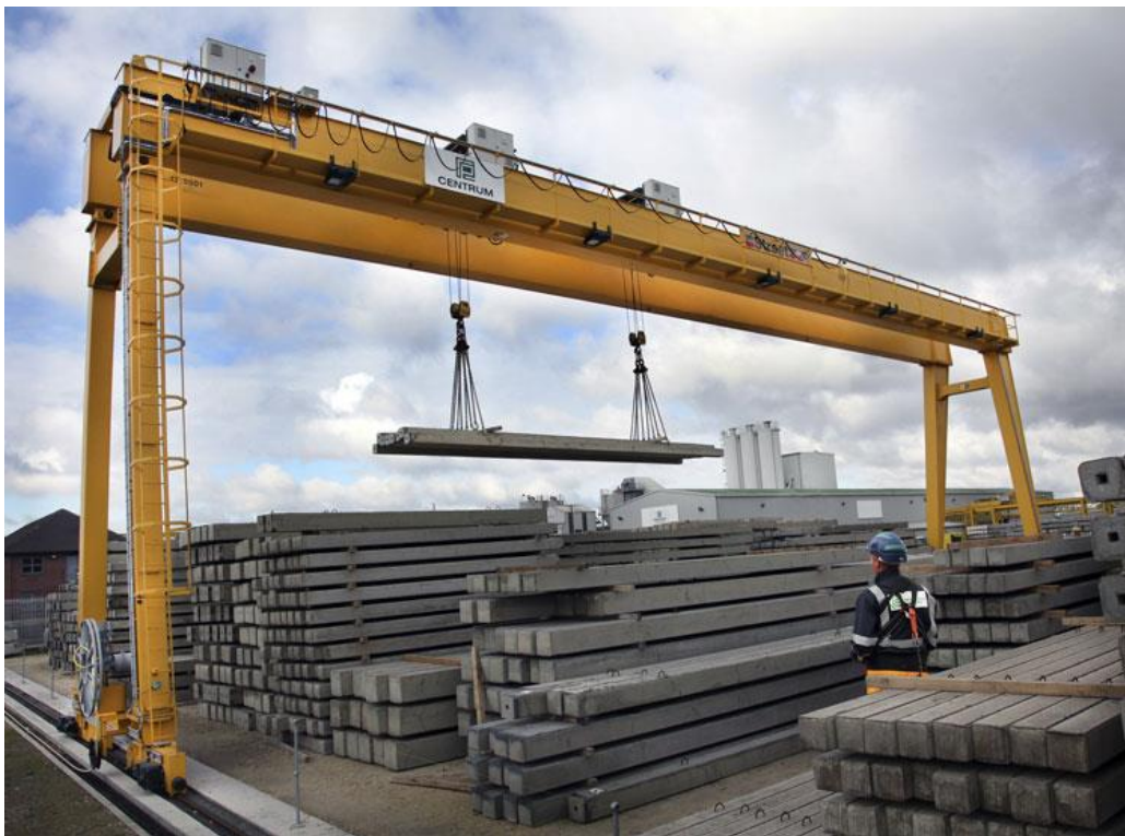
Slika 13.1 Portalna dizalica dizalice
