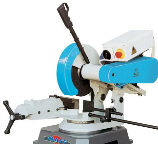
Slika 21.1 Prikaz tarne pile
