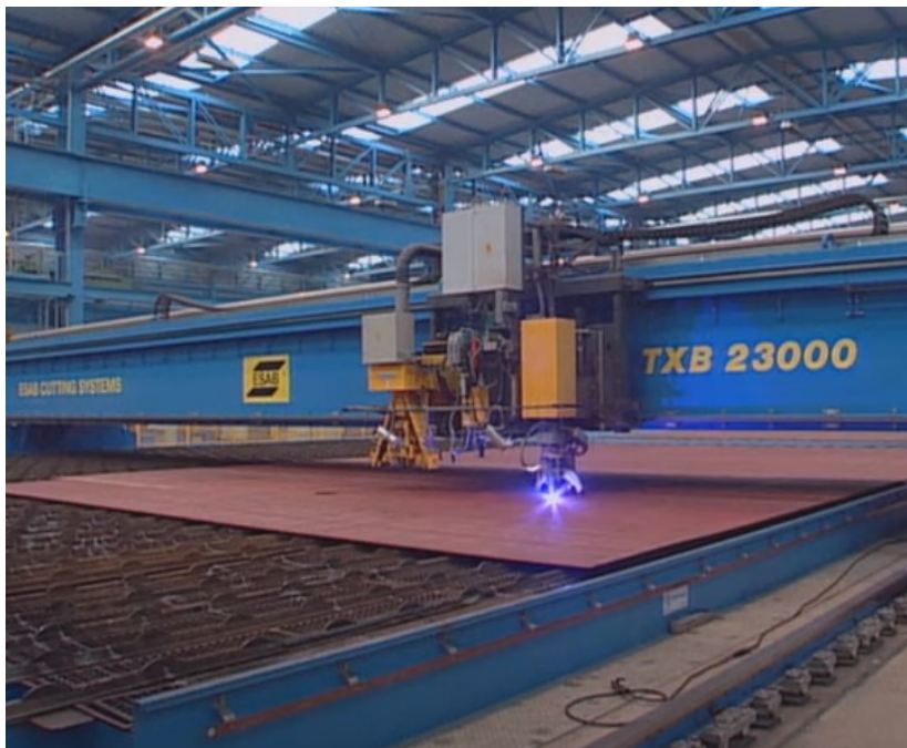
Slika 4.3.1.1. Paralelno plinsko rezanje brodskih limova
